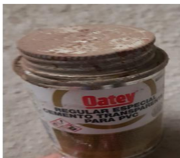
Figura 11: Pegamento vencido y seco
