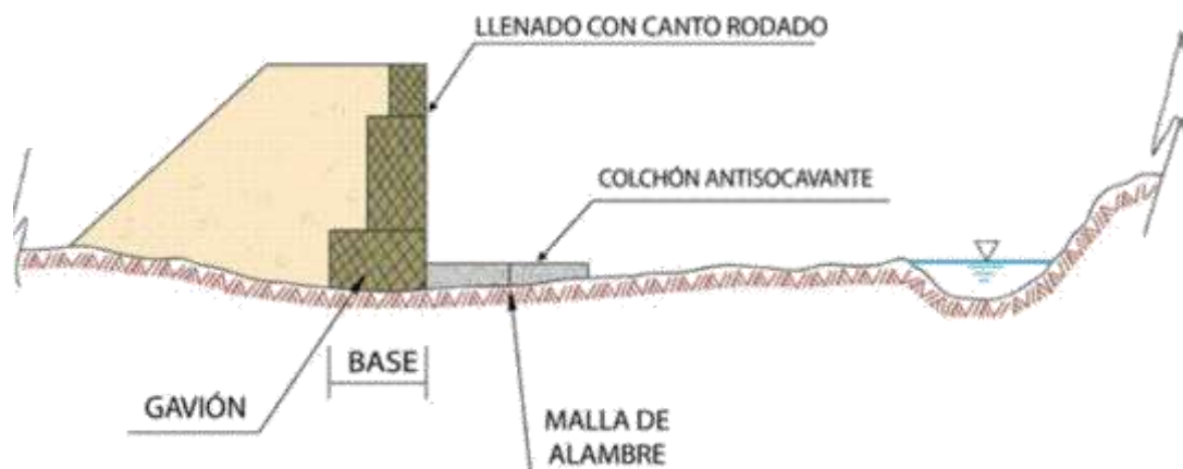
Figura N° 5.13: Vista de Gaviones y eslabón anticavante
