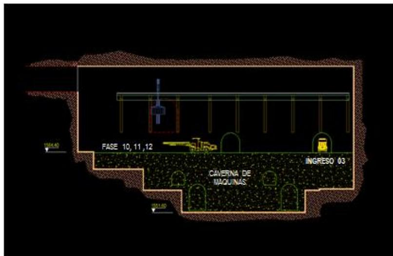
Figura 2.25. Corte longitudinal de caverna de máquinas – fase 10, 11 y 12
