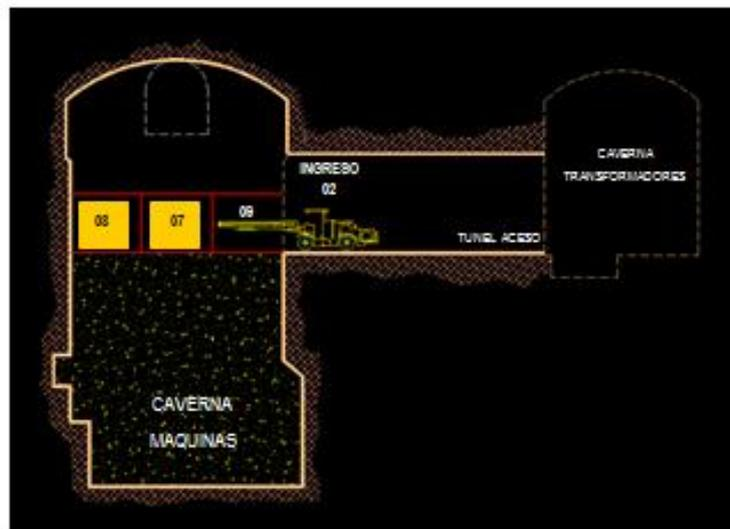
Figura n °2.18. Corte transversal de caverna de máquinas – fase 07, 08 y 09
