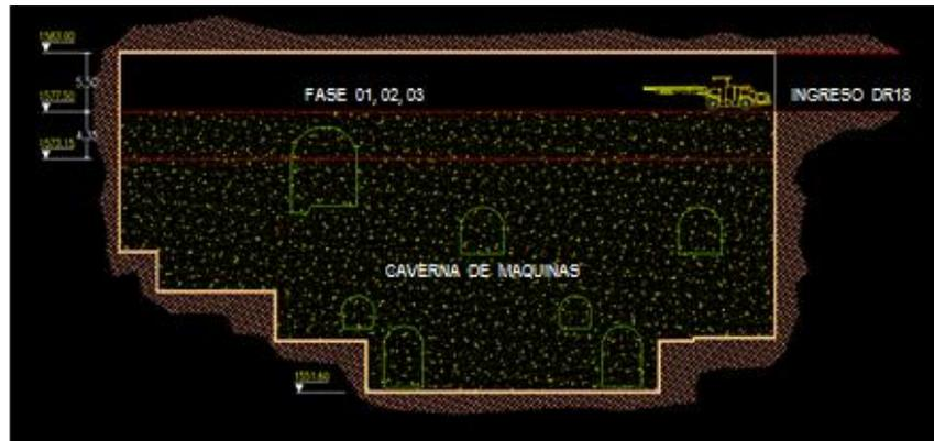
Figura n °2.13. Corte longitudinal de caverna de máquinas – fase 01, 02 y 03
