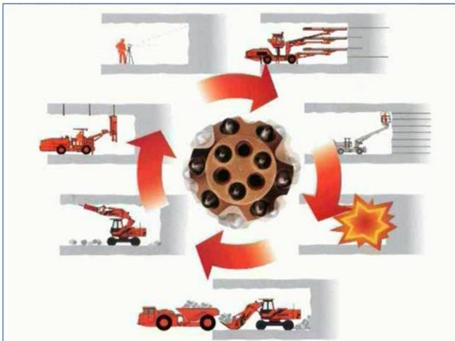
*Figura n °2.5. Ciclo de excavación en túneles*
