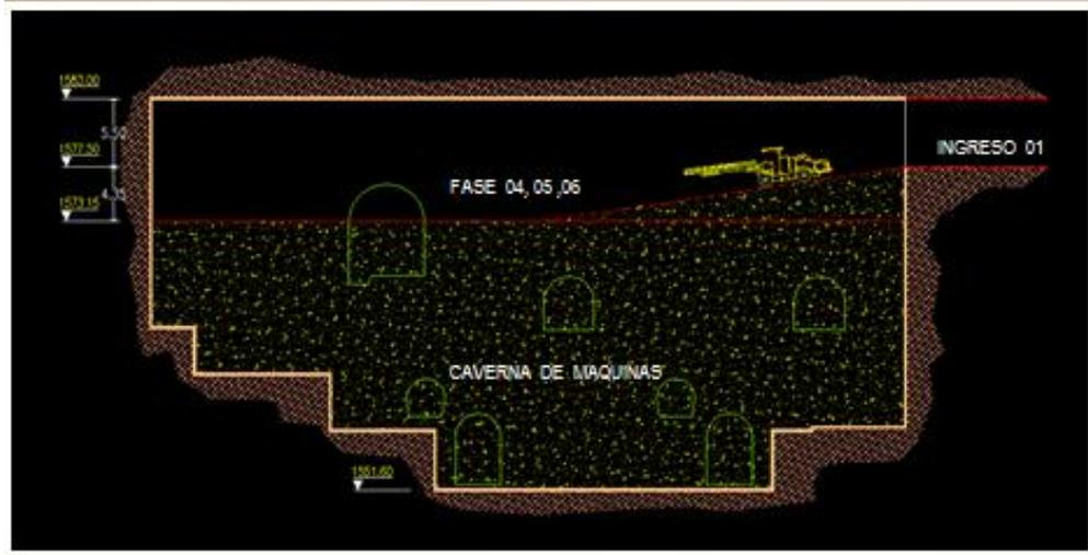
Figura n °2.15. Corte longitudinal de caverna de máquinas – fase 04, 05 y 06
