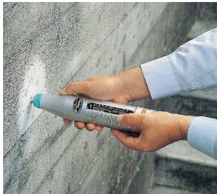
Figura 21 Ensayo de esclerometría Fuente: Sencico
