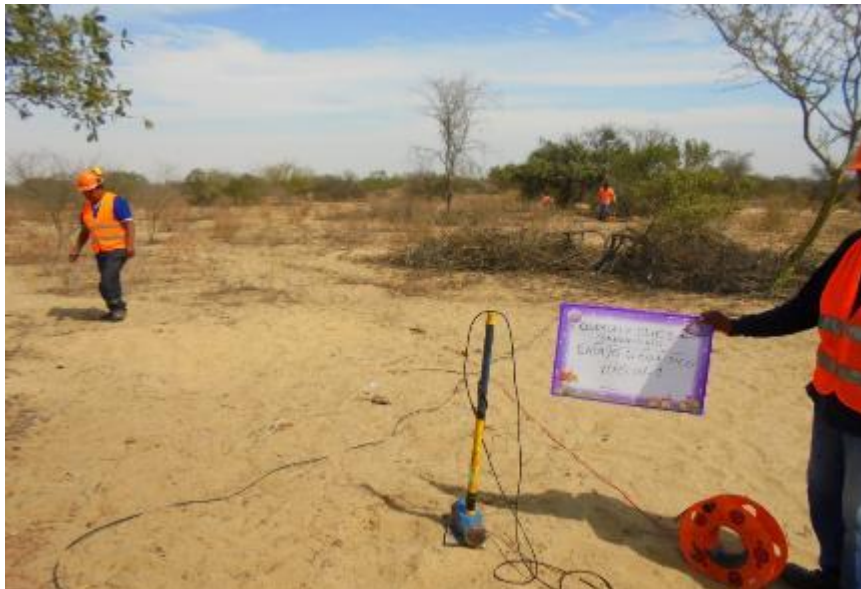
Foto 1. Ensayo MASW – 01 en planta de tratamiento de agua Residual PTAR.
