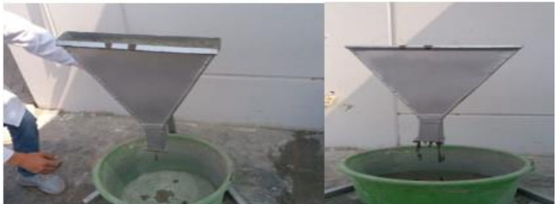
Figura 31: Materiales y equipos para realizar el ensayo embudo V
