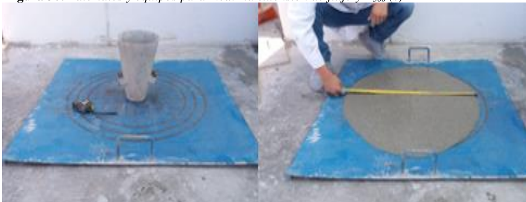
Figura 30: Materiales y equipos para medir la extensión de flujo y T_{500} (s)
