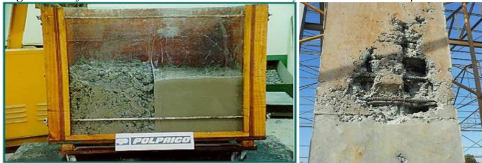
Figura 25: Diferencia entre el concreto convencional y el concreto autocompactante
