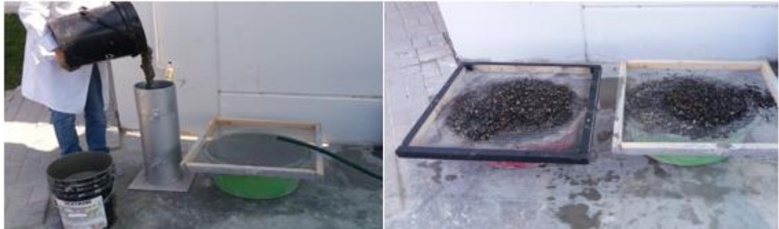
Figura 35: Materiales y equipos para realizar el ensayo de columna de segregación
