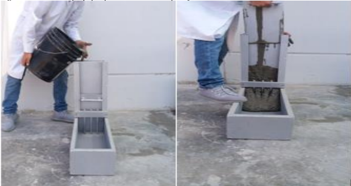
Figura 33: Materiales y equipos para realizar el ensayo caja L
