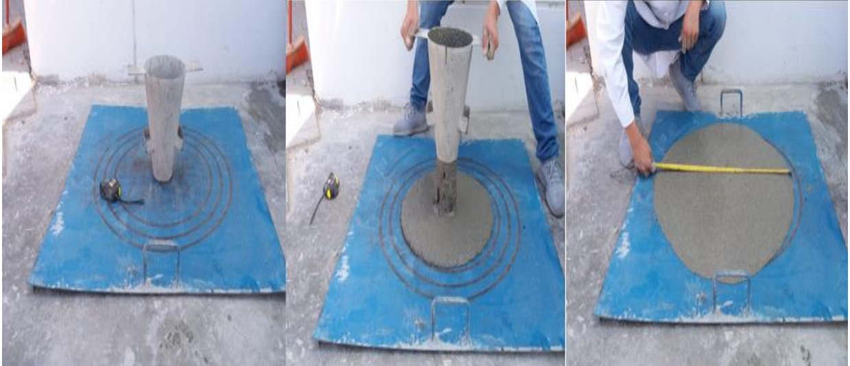
Figura 73: Ensayo de extensión de flujo por cono de Abrams y T_{500}
