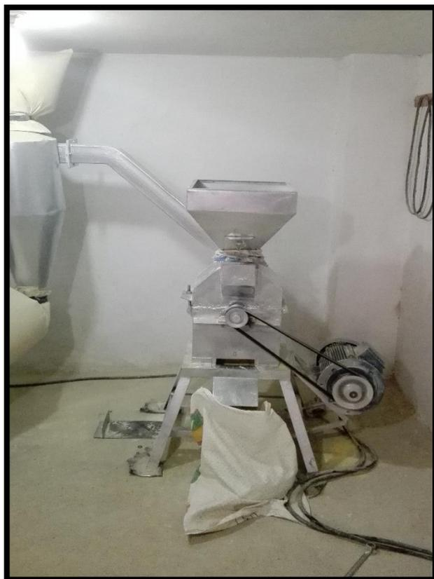
*Figura n° 18.* Máquina para el proceso de transformación de la maca amarilla entera a polvo
