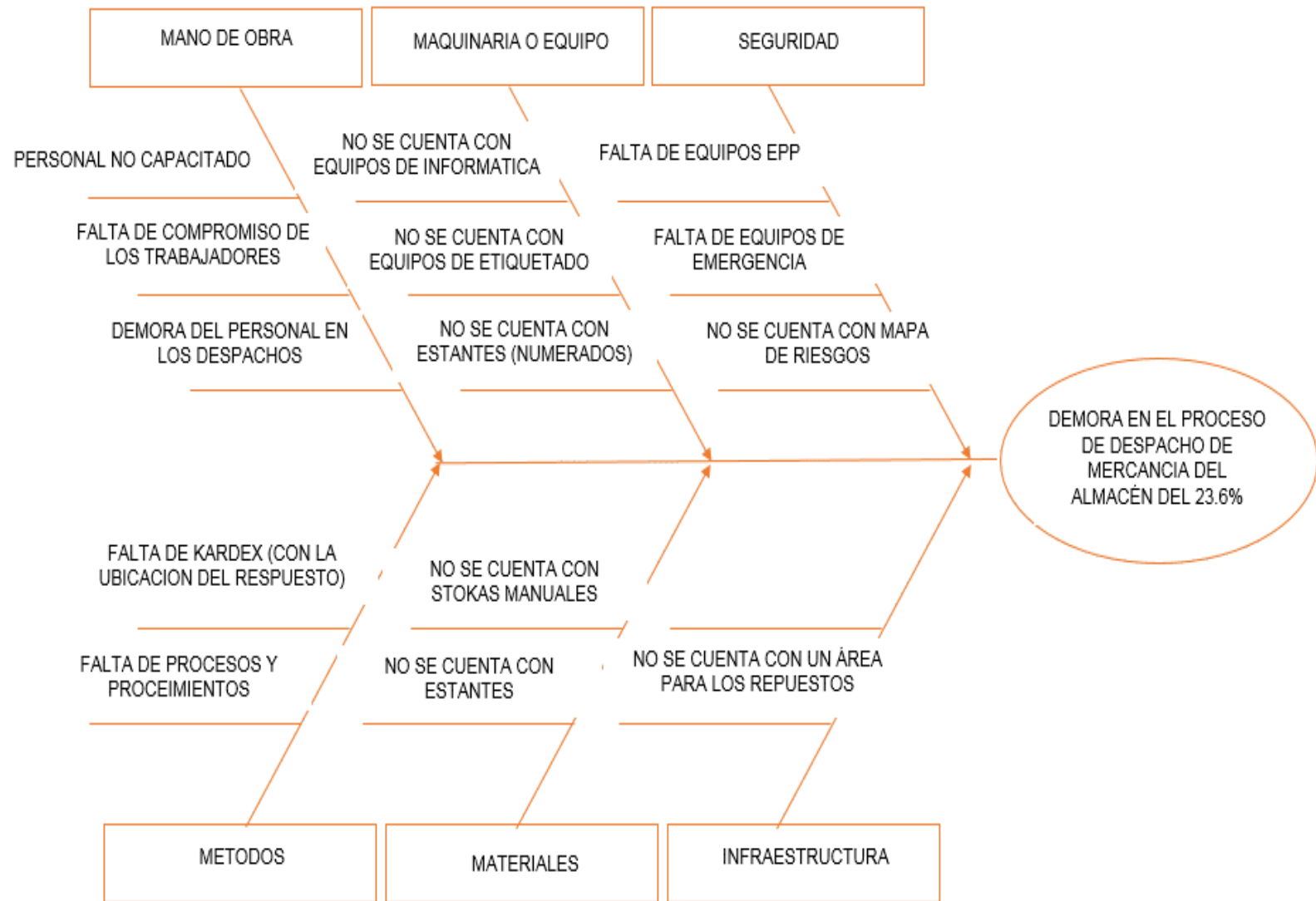
Figura 16. Diagrama de Ishikawa identificando las causas de la demora en el proceso de despacho.
