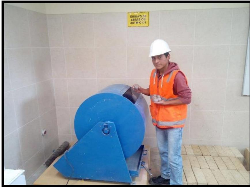
Introduciendo dos esferas de acero a la máquina de Abrasión los Ángeles para obtener el
