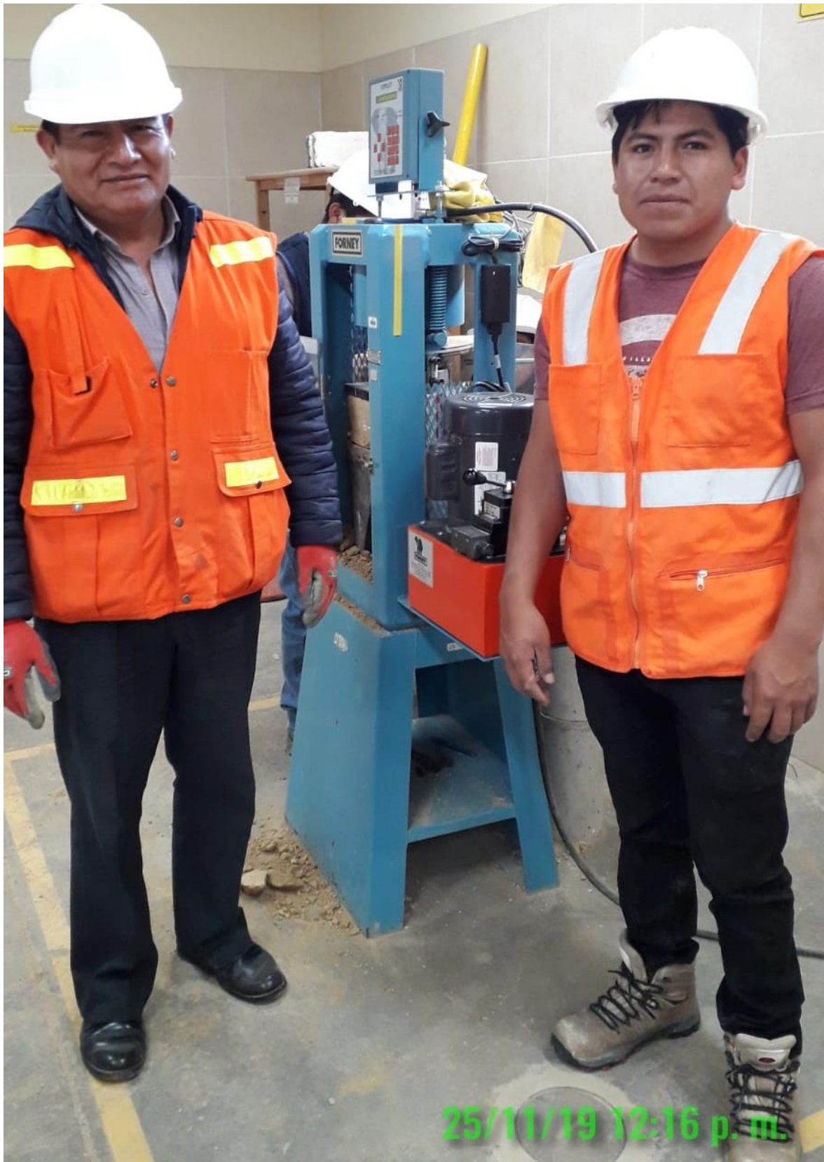
ILUSTRACIÓN 10: Ensayo a compresión axial de los testigos de concreto
