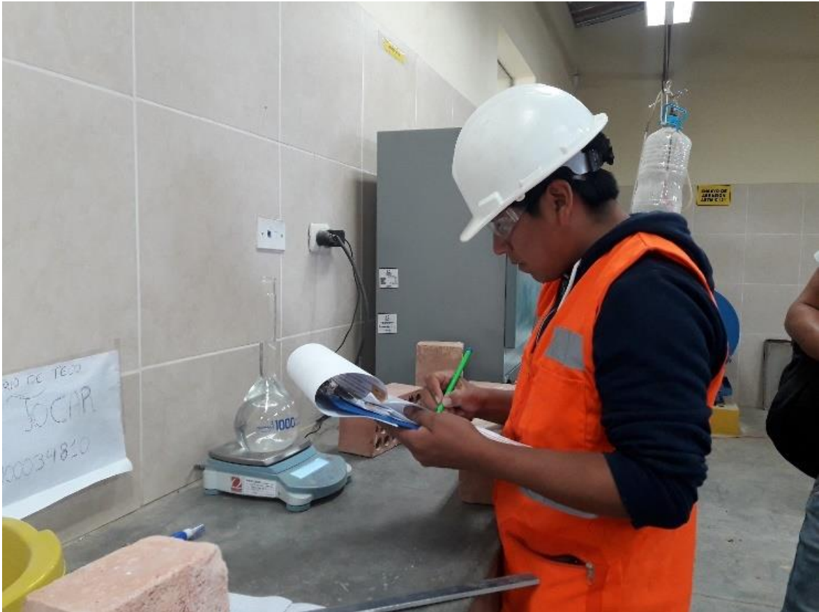
ILUSTRACIÓN 03: Determinación del peso específico del agregado fino.
