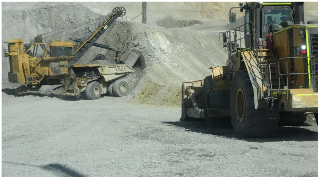
*Figura 41: Presencia de TOES (ondulaciones) en el piso de la zona de carguío.*
