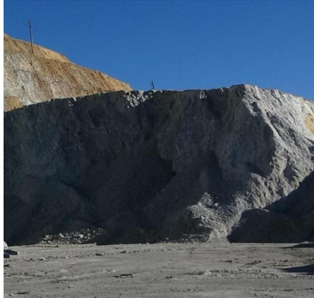
*Figura 36: Nivel de fragmentación del banco que acaba de ser detonado.*
