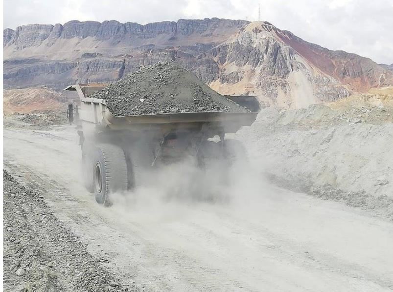
*Figura 40: Material mal cargado, ocasiona mayor desgaste en las llantas del lado derecho del camión.*
