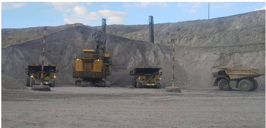
*Figura 43: Disposición del material detonado. Se observa el esponjamiento además de un frente amplio para cargar por dos lados.*
