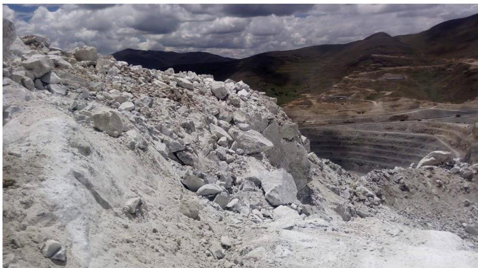
*Figura 39: Bolonería causada por una mala voladura.*
