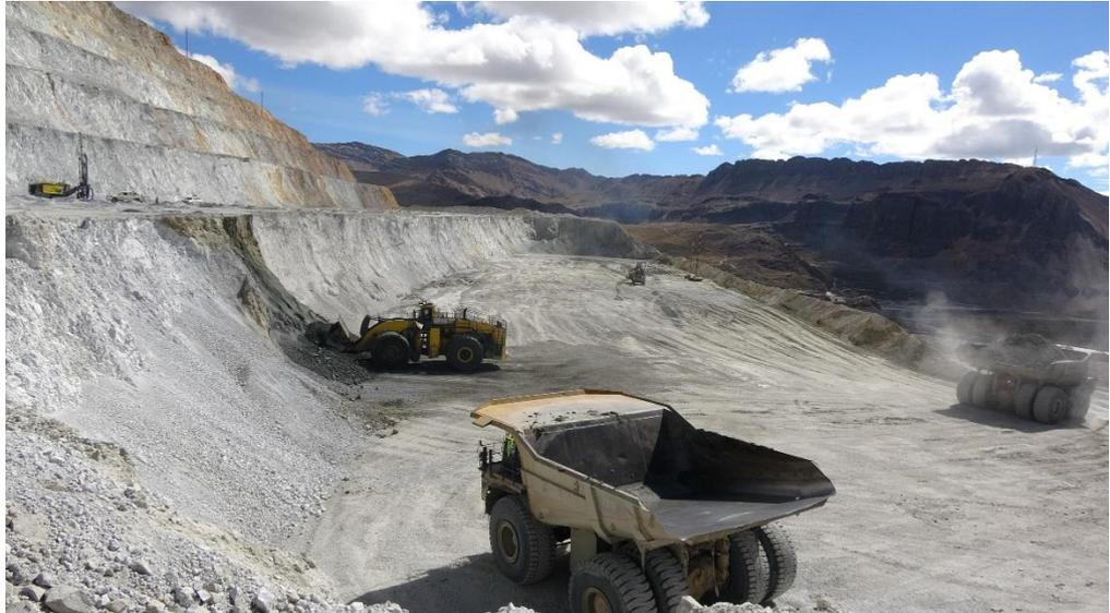
*Figura 42: Ataque poco profundo del cargador frontal debido a la dureza del frente de minado.*
