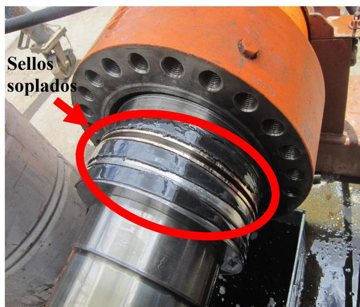
Figura 9. Sellos soplados por exceso de presión durante las pruebas hidrostáticas.
