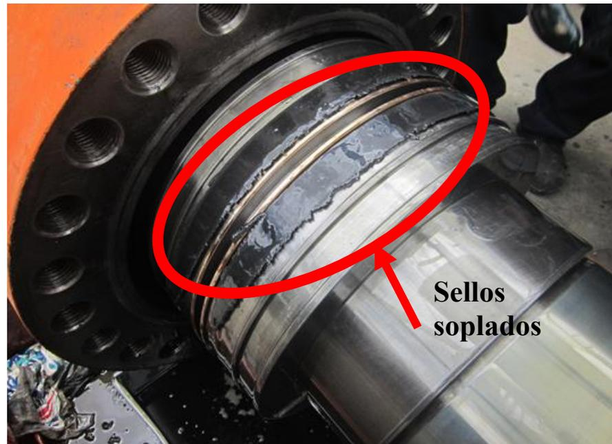
*Figura 10. Sellos de vástago soplados por exceso de presión durante las pruebas hidrostáticas.*
