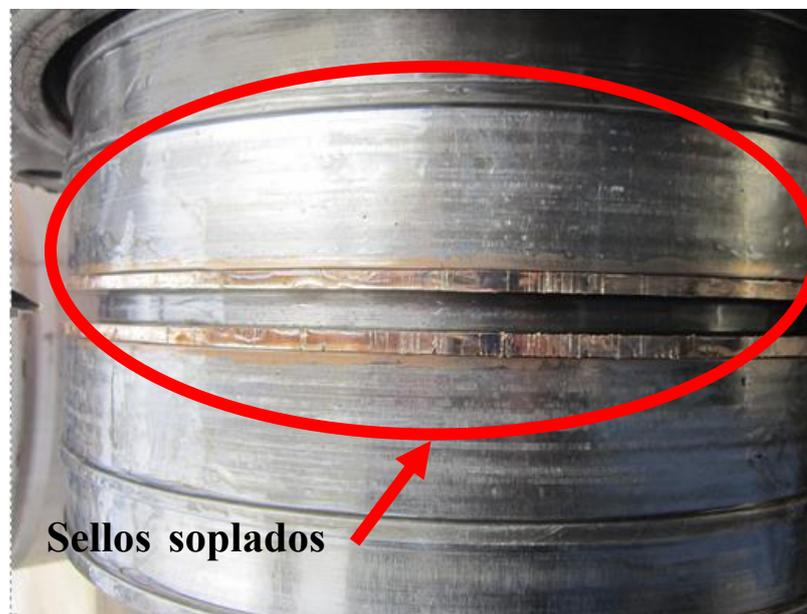
*Figura 11. Sellos de vástago soplados por exceso de presión durante las pruebas hidrostáticas.*
