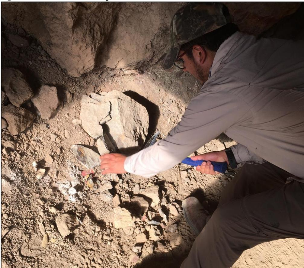
**Figura 13:** recolección de las muestras para el análisis de compresión uniaxial.
