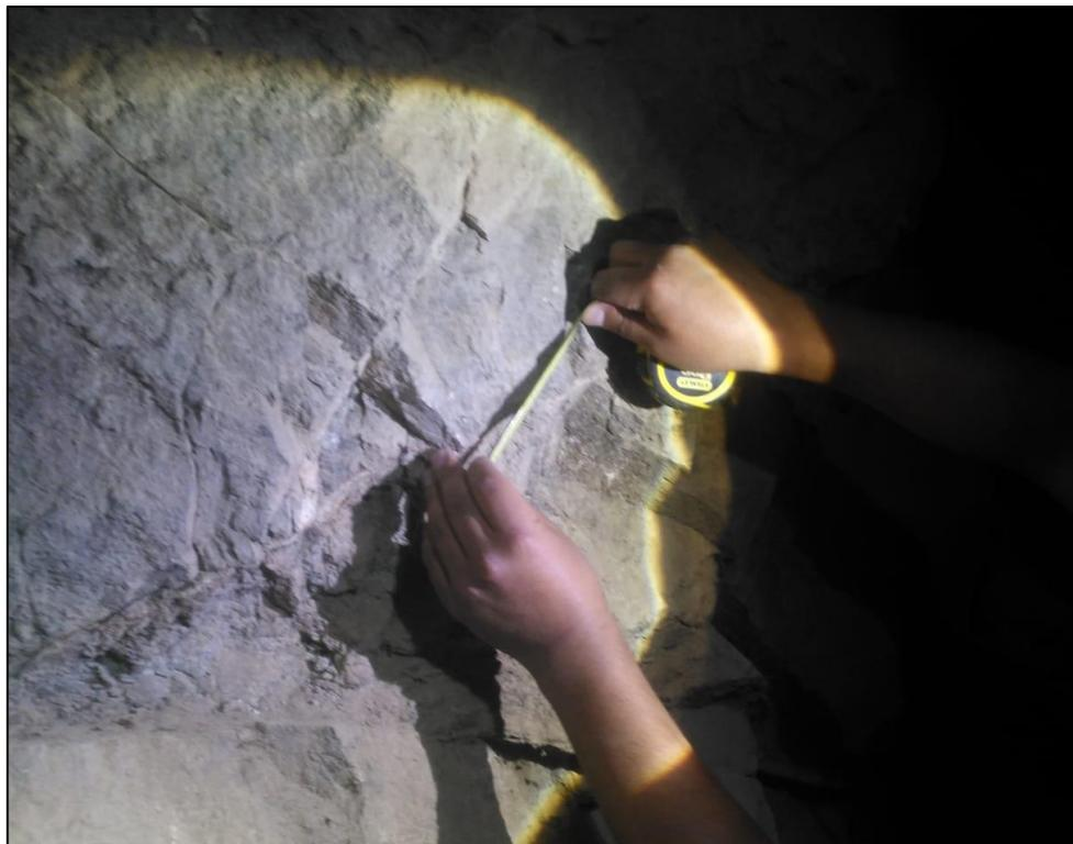
*Figura 35.* Recubrimiento de las discontinuidades con minerales arcillosos.
