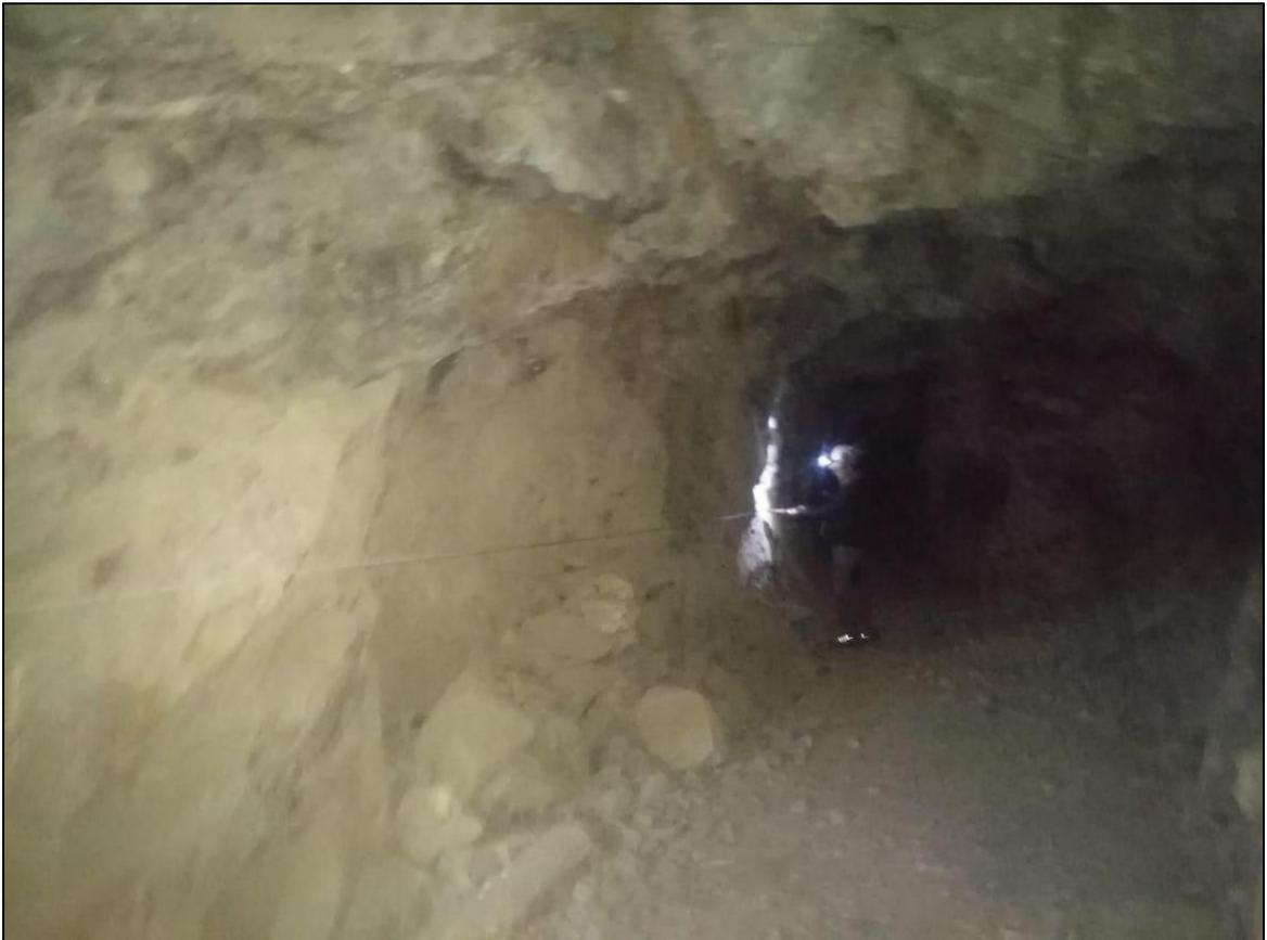
*Figura 45.* Medición de tramo de conteo de discontinuidades.
