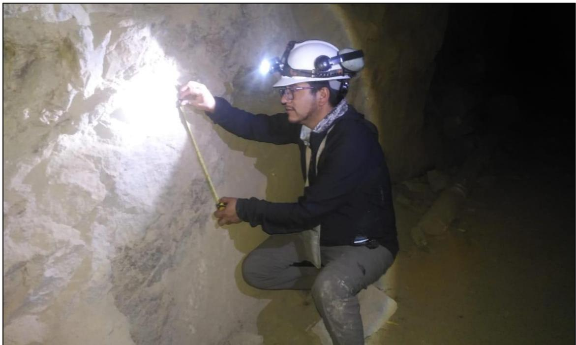
*Figura 42.* Medición de persistencia de la discontinuidad.
