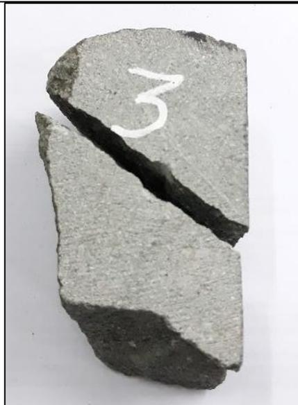
Figura 16. Muestra 3 de resistencia a la compresión uniaxial.
