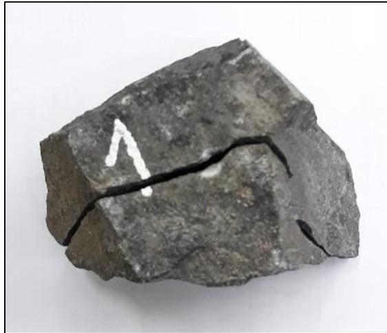
Figura 14. Muestra 1 de resistencia a la compresión uniaxial.
