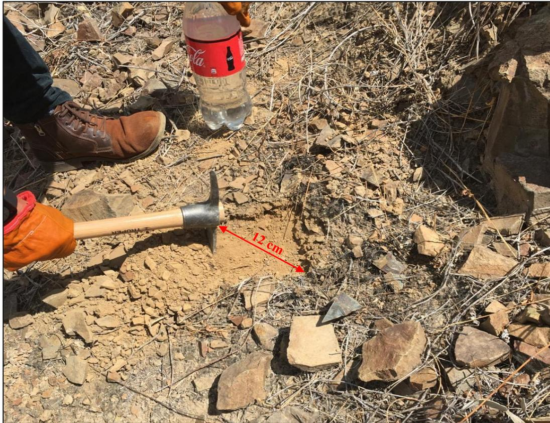
Figura 20. Agujeros para los puntos de infiltración.
