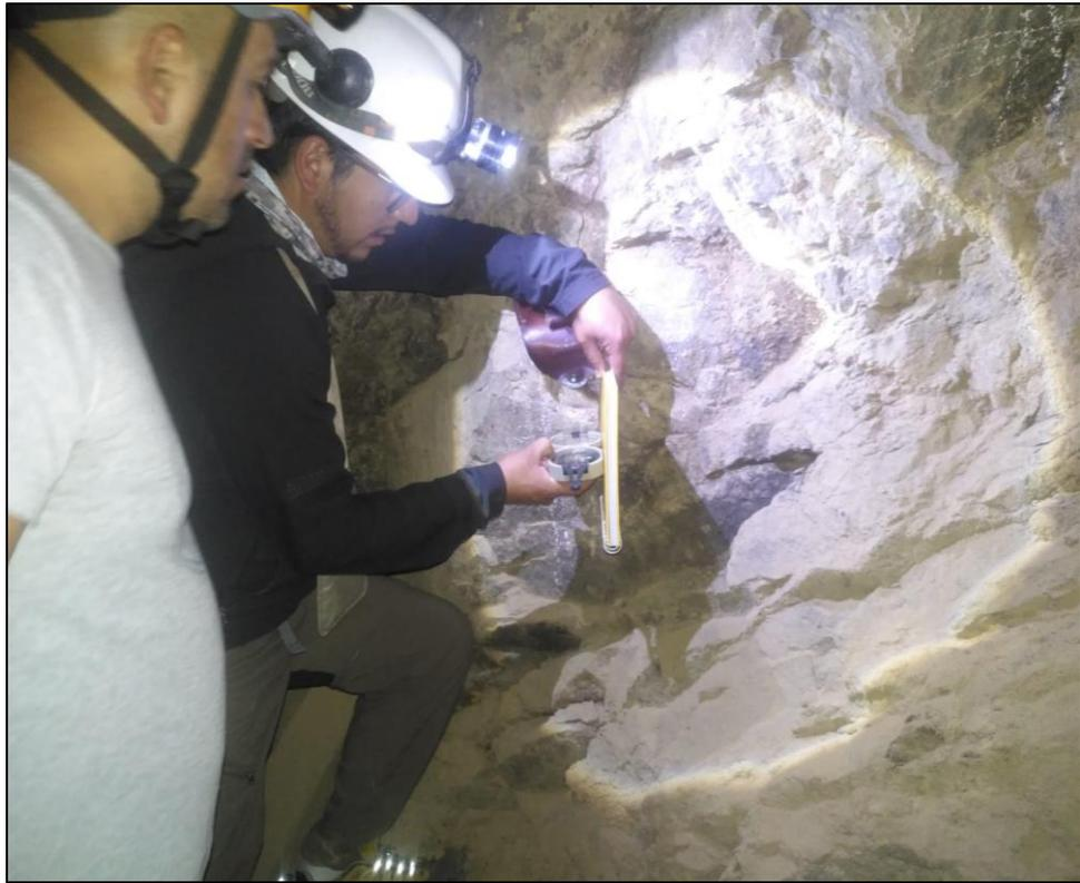
**Figura 6:** Toma de rumbo y buzamiento en estructuras.
