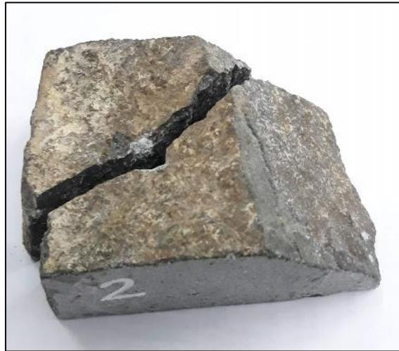
Figura 15. Muestra 2 de resistencia a la compresión uniaxial.
