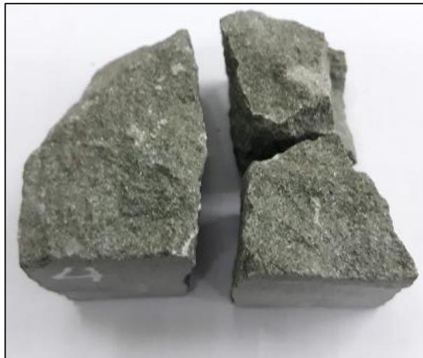
Figura 17. Muestra 4 de resistencia a la compresión uniaxial.
