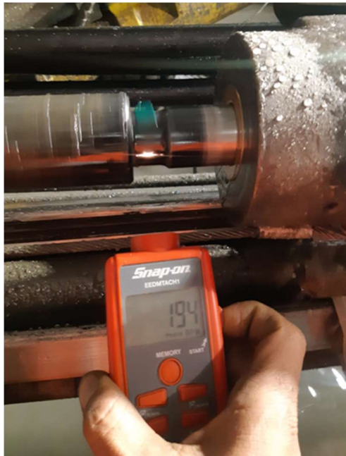
Figura 4 Estandarización de RPM en los equipos de perforación para el uso de brocas magnum de 45 mm
