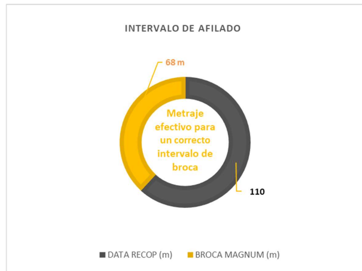
Figura 43 Intervalo de afilado por broca
