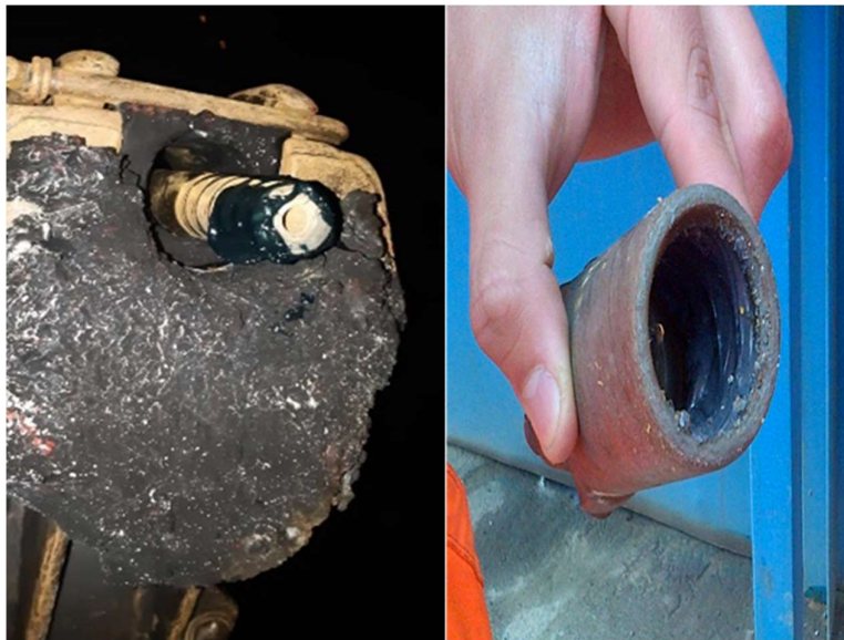
Figura 15 Engrase de uniones roscadas
