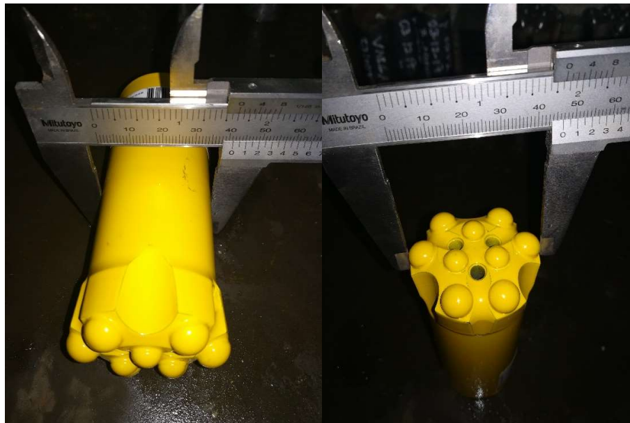
Figura 11 Verificación diametral de broca nueva
