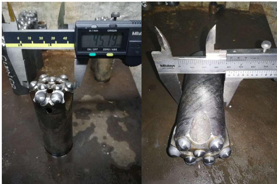
Figura 18 Verificación diametral de desgaste
