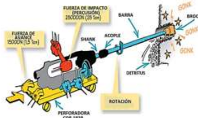
Figura 3. Principio de perforación TOP HAMMER.
