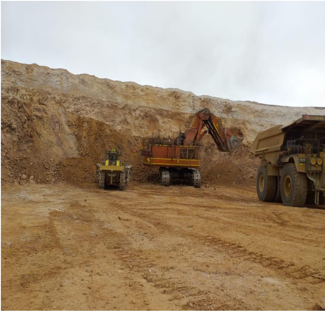
Foto 1: Pala EX5500 en su frente de minado presentando el cucharón para carguío por el lado derecho
