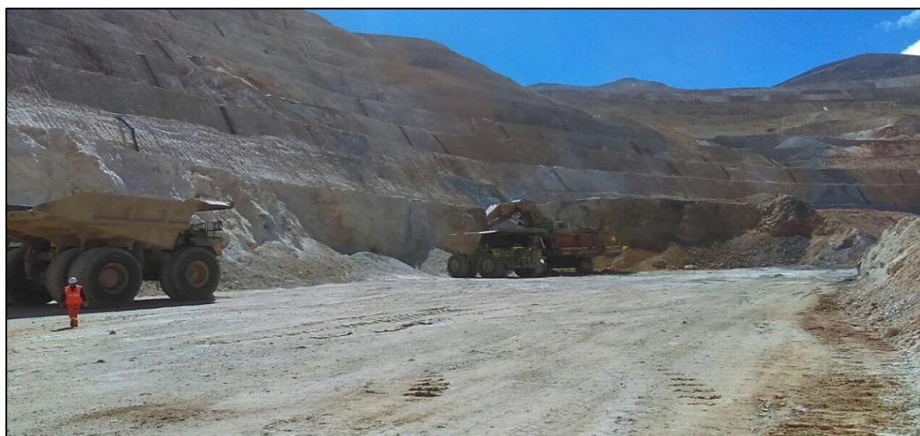
Ilustración 6: Carguío de material en piso estable Temporada Seca (agosto).
