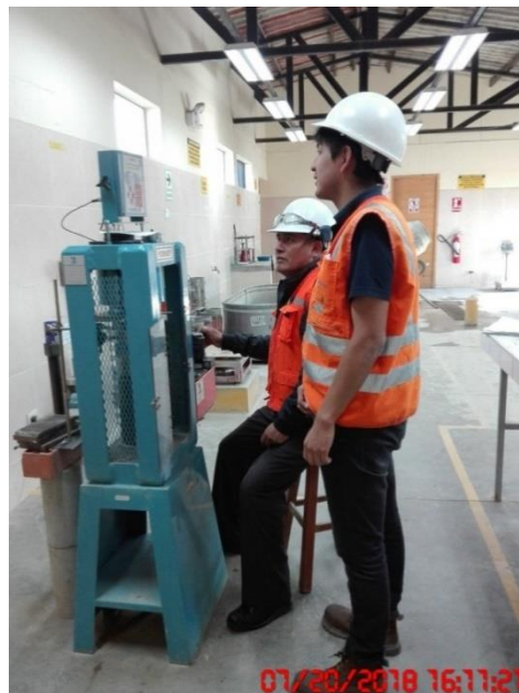
Fotografía 15: Ensayo de resistencia a compresión de morteros a 28 días
