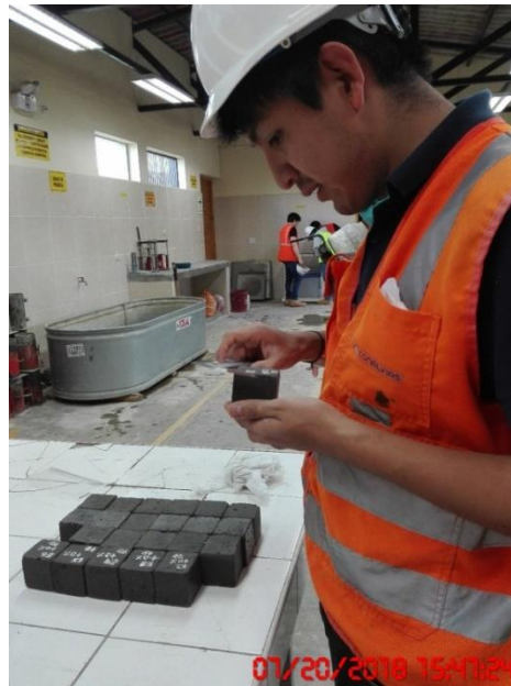
Fotografía 14: Toma de medidas de morteros previo a su ensayo
