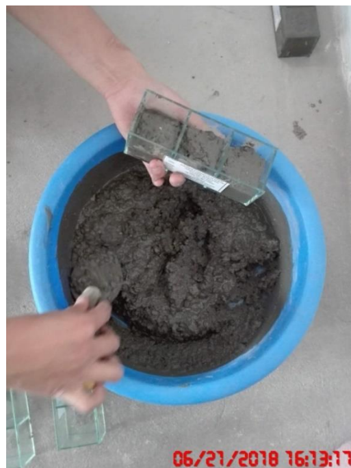
Fotografía 12: Llenado de moldes con mezcla de mortero
