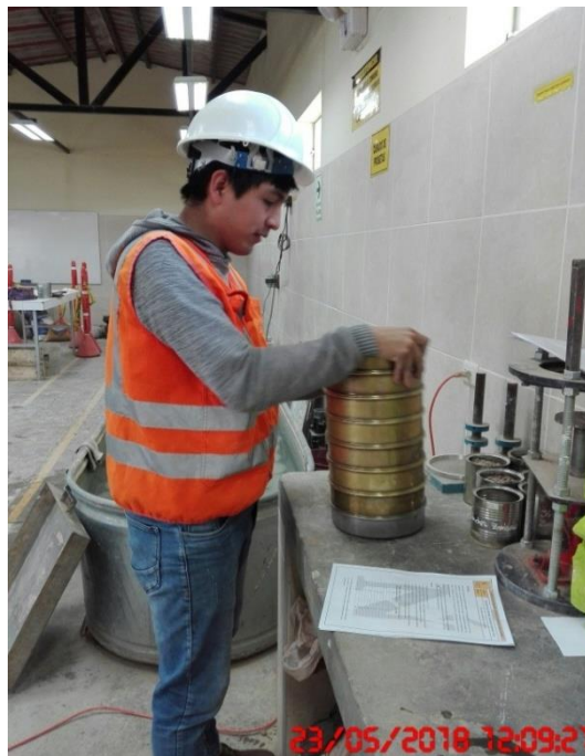
Fotografía 2: Tamizado del agregado fino
