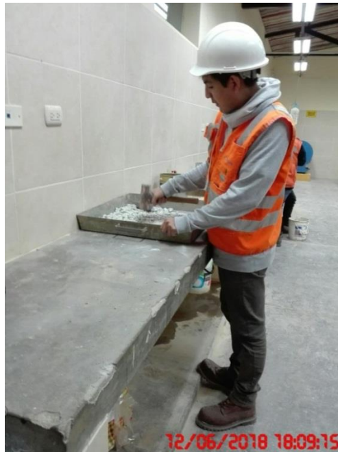
Fotografía 8: Triturado de la roca volcánica de forma manual
