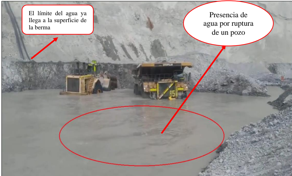
Figura n°6 descripción del trabajo de carguío y acarreo influenciado por ruptura de un pozo profundo
