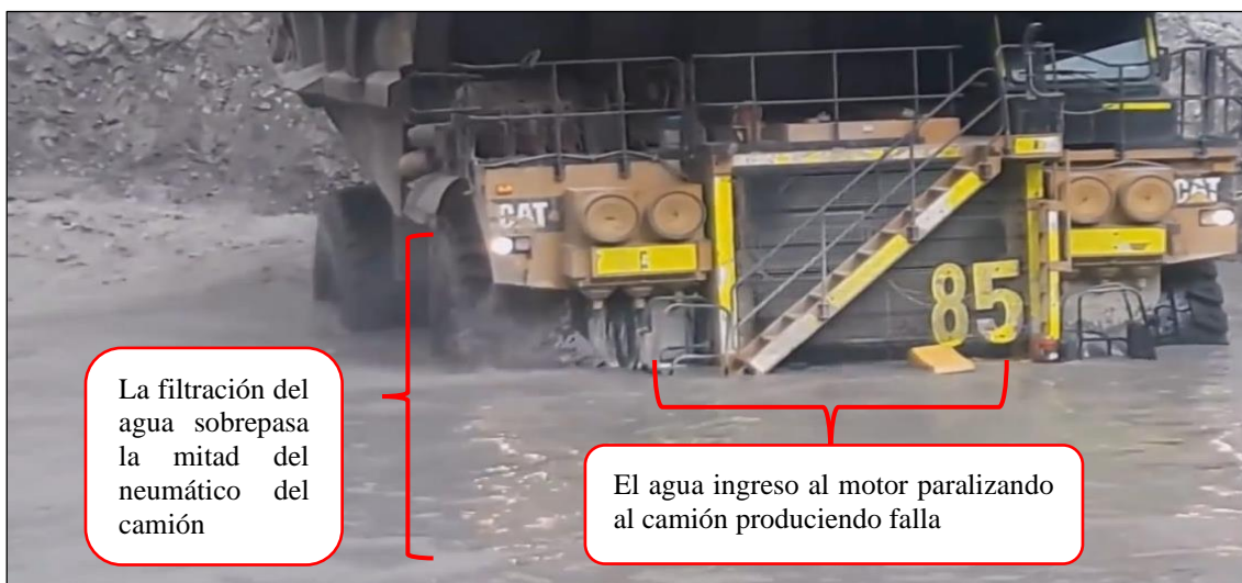
Figura n°5. Camión averiado en operaciones mina por ruptura de un pozo profundo.
