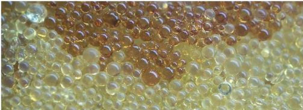
*Figura 4.* Resinas Catiónicas y Aniónicas. Fuente: (Aguasalud, 2011).
