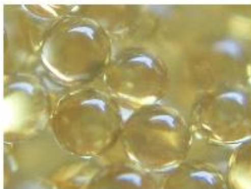
**Figura 3.** Resinas de Intercambio Iónico.
