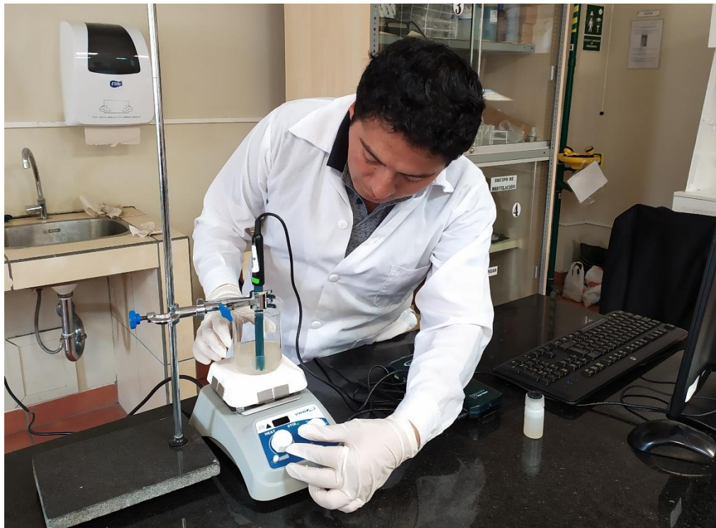
Figura 19. Proceso de agitación y medición de pH.
