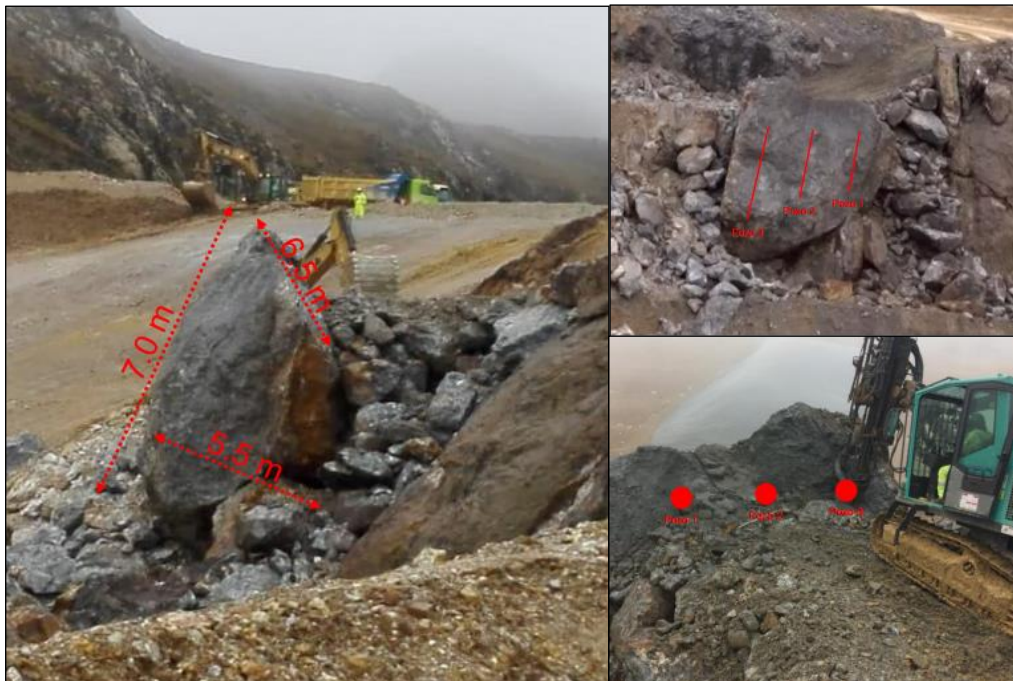
Figura 16. Diseño de la Fractura Secundaria con tecnología Plasma Fuente: Imagen tomada de un Proyecto Minero en Minería Superficial en la Región Cajamarca (Se reserva el nombre de la operación minera por tratarse de información confidencial)
