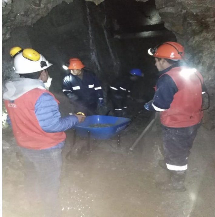
Figura 6. Carguío de mineral en carretillas antes de usar el carro minero.
