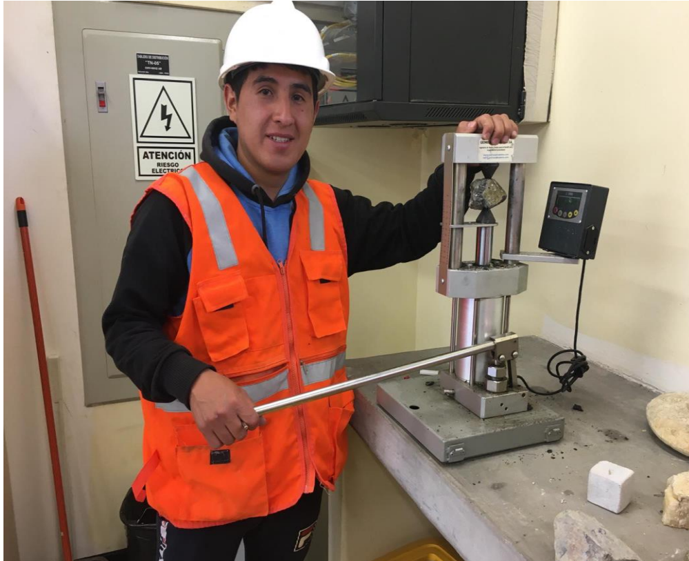
Figura 13. Ensayo de carga puntual.
