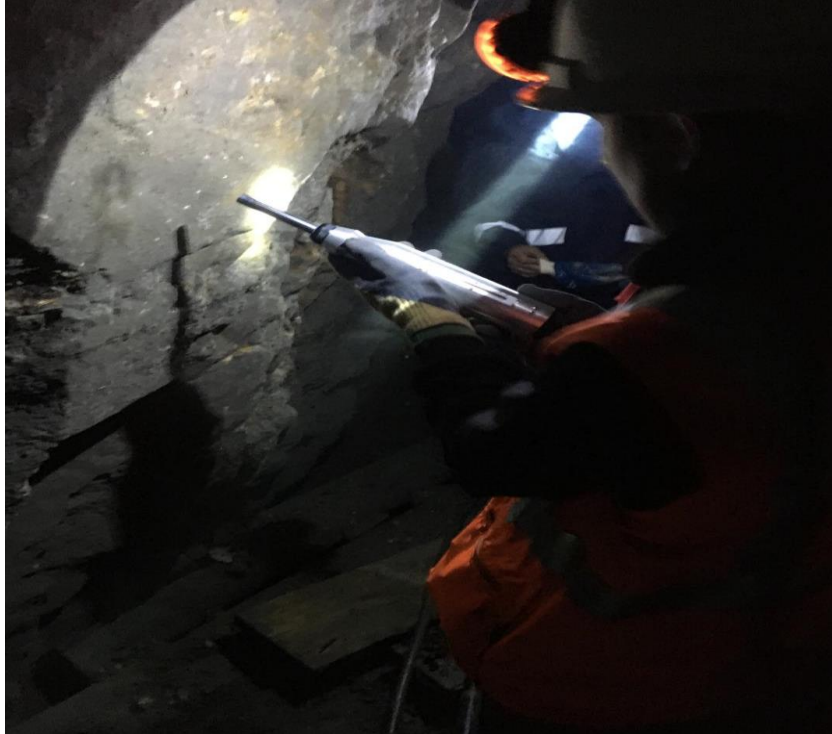
Figura 10. Prueba de resistencia del macizo con el Martillo de Schmidt lado caja.
