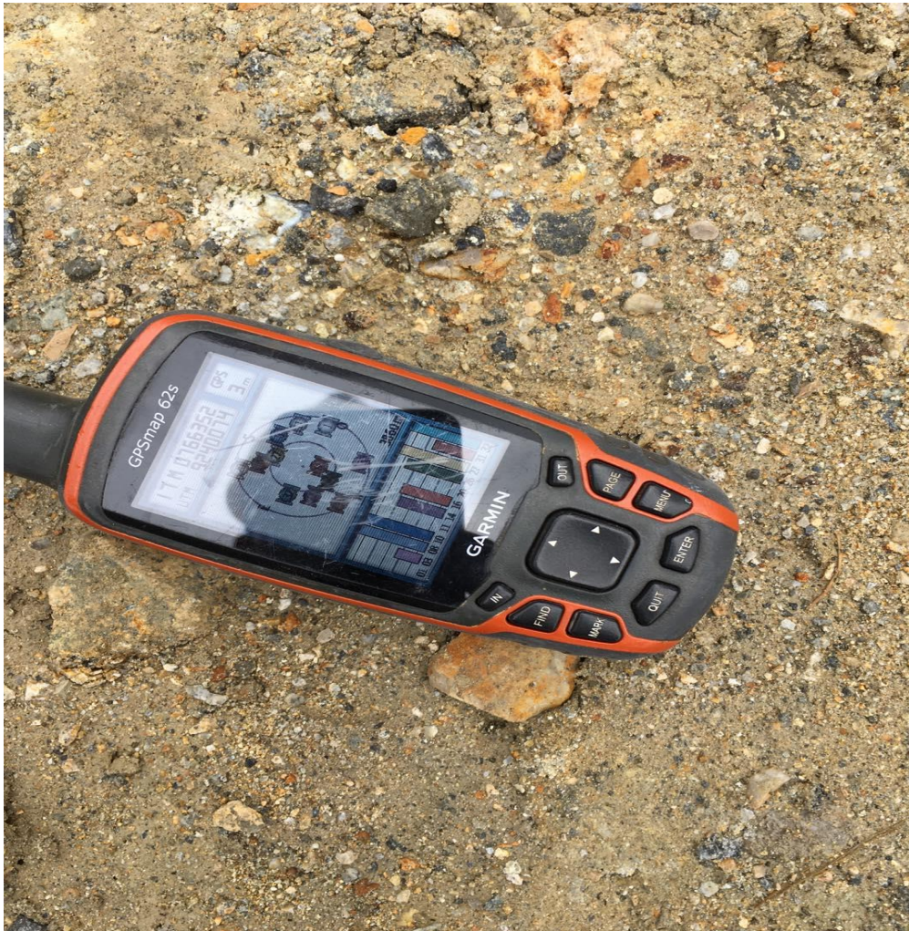
Figura 14. Toma de su punto GPS de bocamina.
