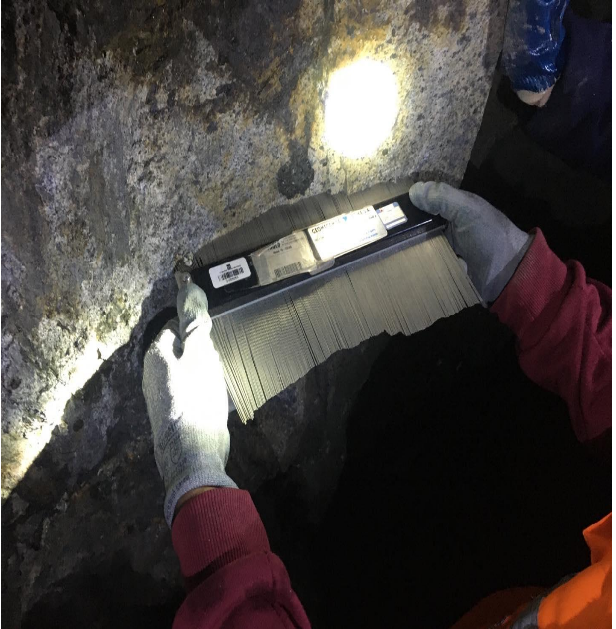
Figura 9. Medición de la rugosidad del macizo con el Peine de Barton.
