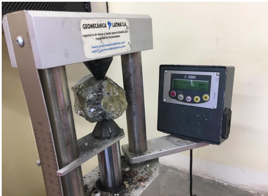
Figura 12. Ensayo de carga puntual a las muestras del mineral.
