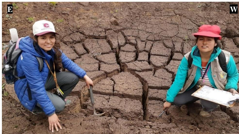
Figura 25. Grietas de desecación por la posible presencia de una microlaguna, presentan estratificación debido a los aportes de sedimentos de los cuatro lados de la microlaguna. Este: 794649, Norte: 9206618 y Cota: 3091 m. Fuente: Propia (2019).
