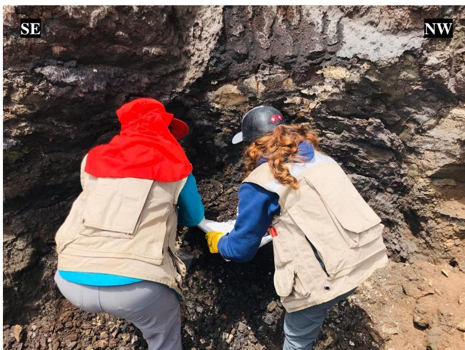
ANEXO N°16. Muestra N°5 obtenida de uno de los afloramientos de Mn mediante el método de puntos o rock chips, consta de realizar el muestreo en diferentes puntos de mineralización.
