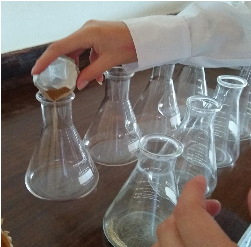
Agregando 10 y 20 gr de muestra molida en cada uno de los matraces
