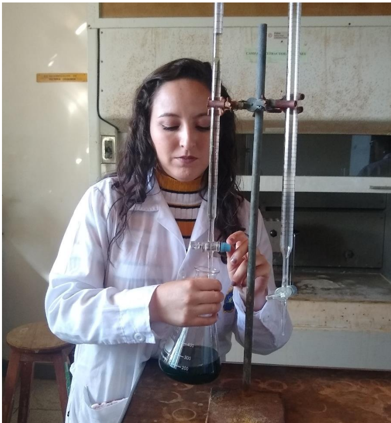
Realizando la titulación con sulfato ferroso amoniacal
