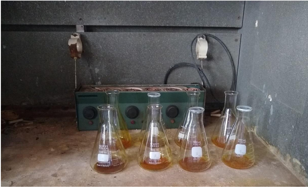
Muestras con K_2Cr_2O_7 1N y H_2SO_4 concentrado en la campana extractora de gases
