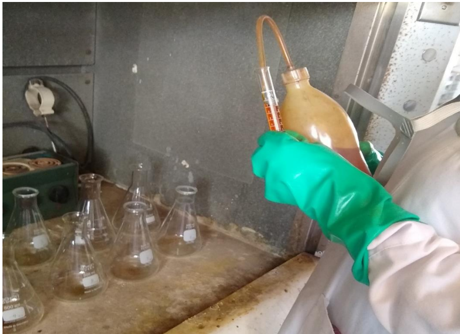
Agregando 10 mL de Dicromato de potasio K_2Cr_2O_7 1N
