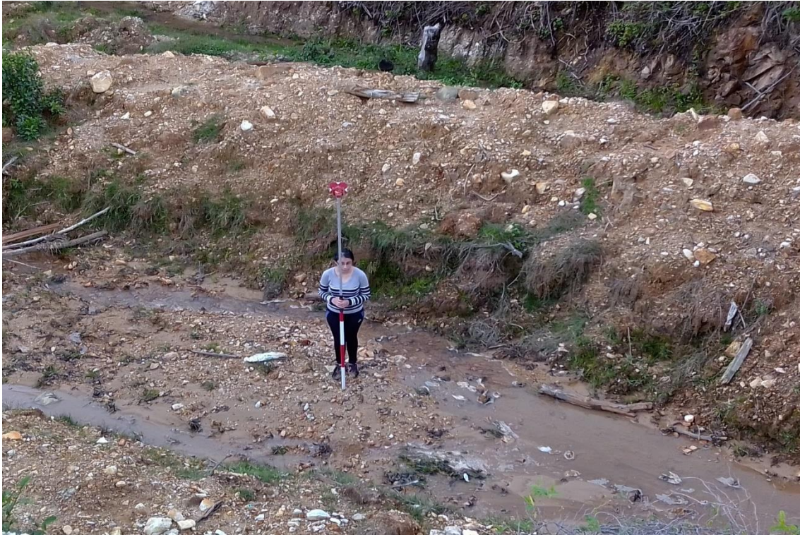
Figura 57. Levantamiento topográfico de la parte baja donde se encuentra el socavón.
