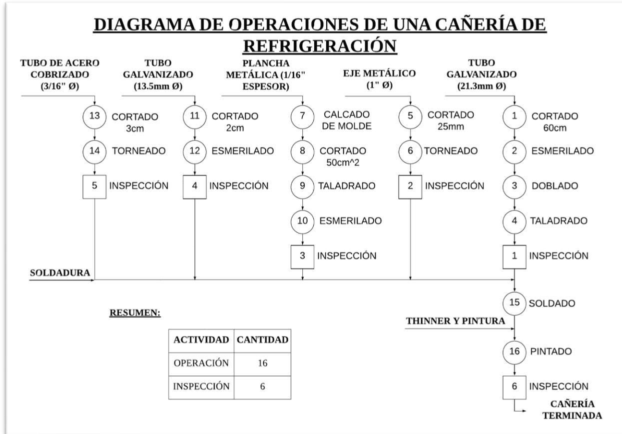
Figura 16. Diagrama de operaciones. Basado en el proceso de fabricación de cañerías de la empresa Talleres Unidos Ingeniería e Inversiones S.A.C
