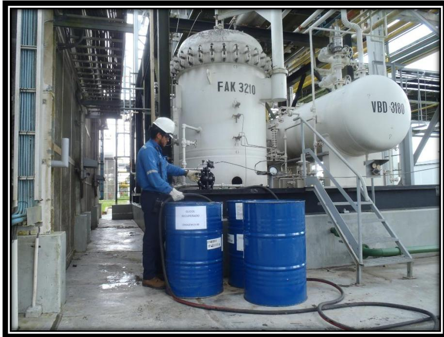
*Figura 29: Procedimiento de Recuperación de TEG Residual*
