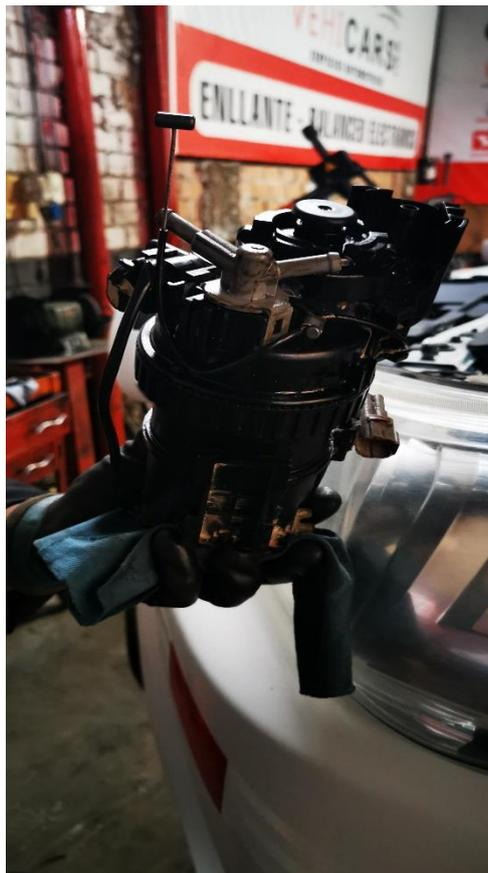
Figura 11. Bomba de filtro de combustible, lo cual se realizó el cambió de filtro de combustible.
