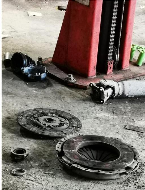
Figura 10. Disco de embrague que serán reemplazado.
