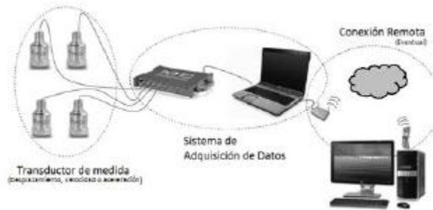
Figura 29. Sistema de Monitoreo Dinámico de Estructuras (Elab. Propia)
