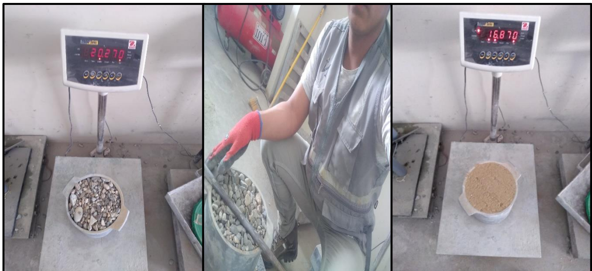
Figura. 37 Ensayo de peso unitario del agregado Grueso y Fino.
