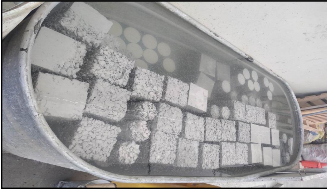
Figura. 45 Curado del concreto permeable de las probetas para Compresión, Flexión y permeabilidad.
