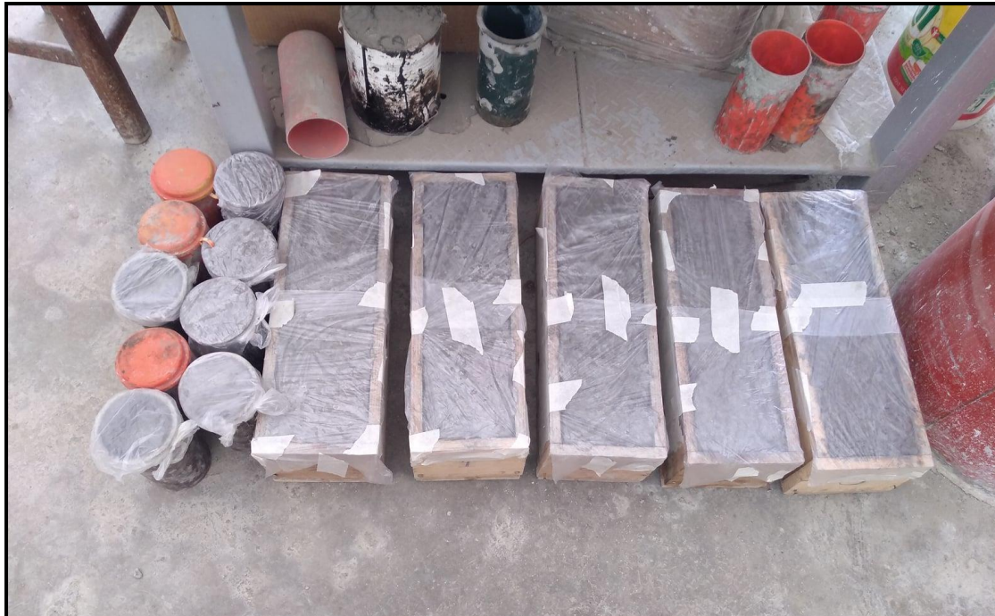
Figura. 43 Testigos cubiertos con plástico para no perder Humedad.
