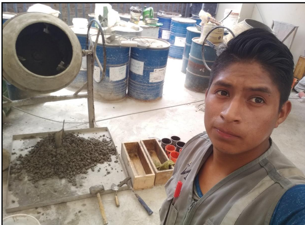
Figura. 42 Elaboración de Probetas cilíndricas y vigas de concreto permeable.
