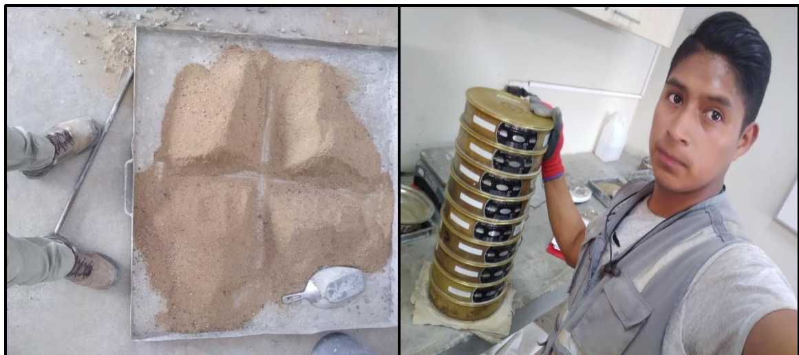
Figura. 35 Análisis granulométrico del agregado Fino (cuarteo y tamizado)
