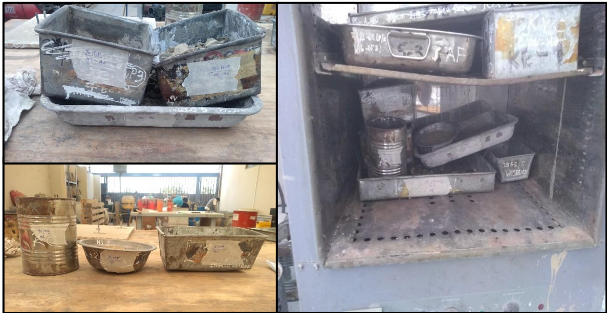
Figura. 36 Ensayo de contenido de Humedad del agregado Grueso y Fino.
