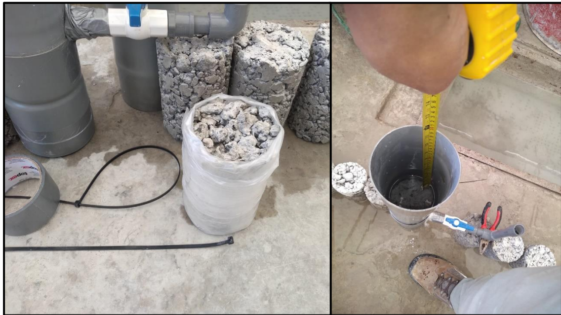
Figura. 51 Ejecución del ensayo de permeabilidad.
