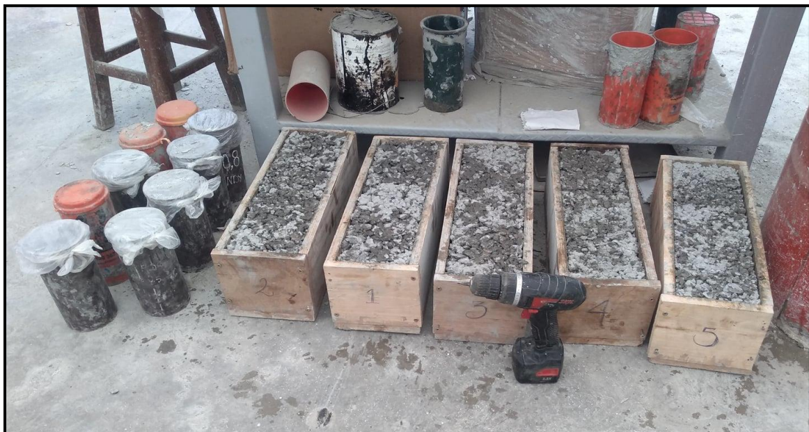
Figura. 44 Desencofrado de Probetas cilíndricas y Vigas a los 28 días de curado.
