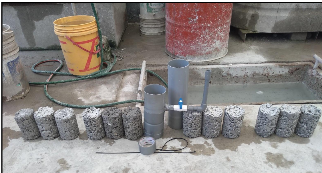
Figura. 50 Probetas y equipo para el ensayo de permeabilidad.
