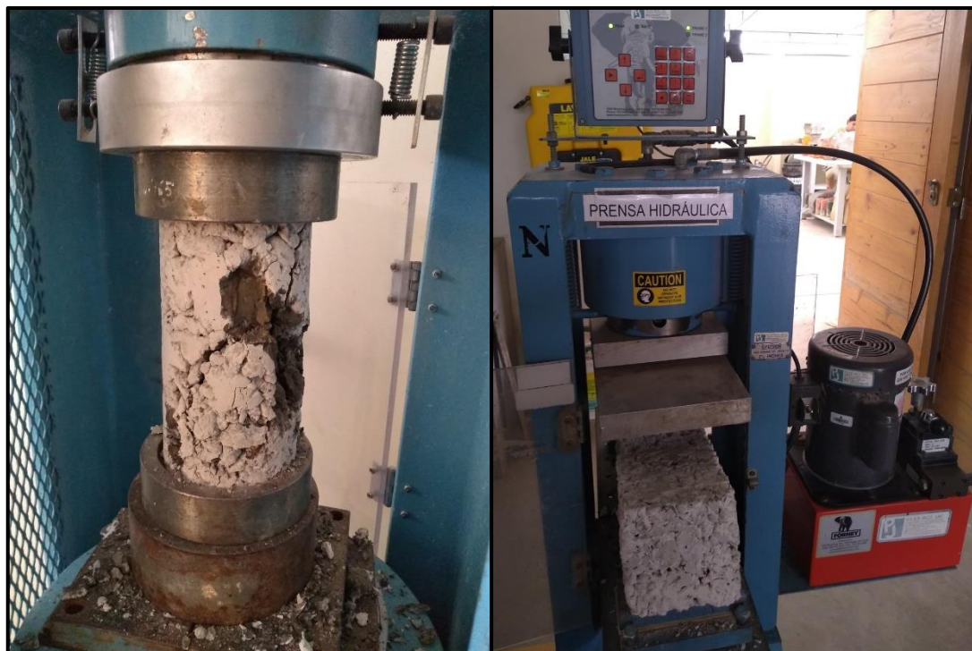
Figura. 48 Ensayo de Resistencia a la compresión y Flexión del concreto permeable.
