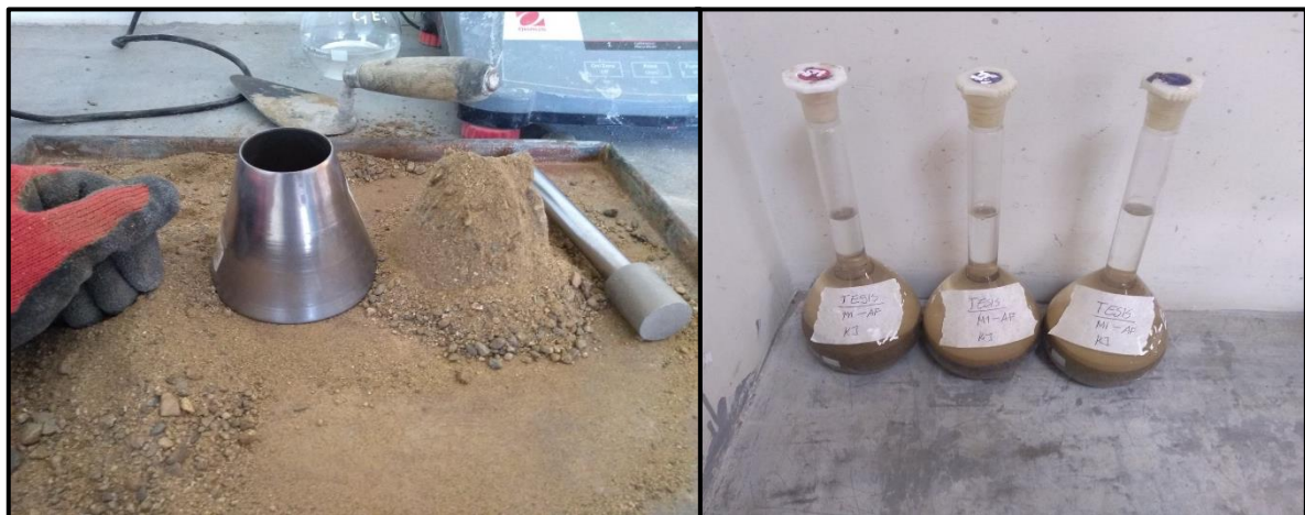
Figura. 39 Ensayo de Peso Específico y Capacidad de absorción del agregado Fino.
