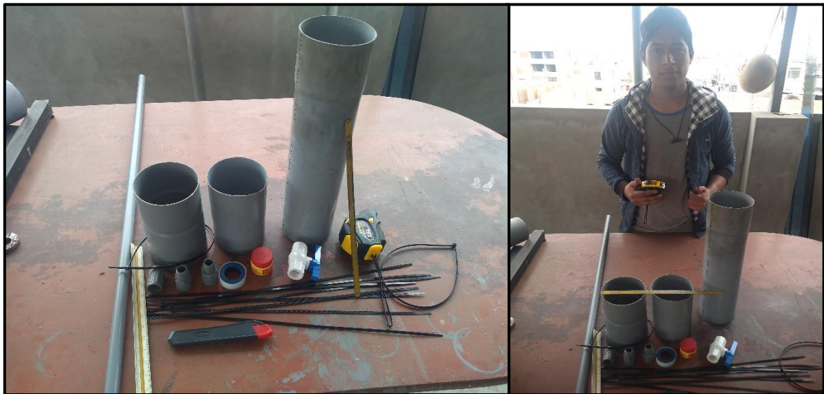
Figura. 49 Elaboración del equipo Permeámetro de carga variable.
