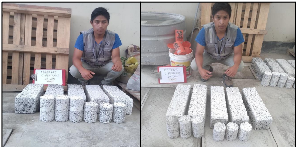
Figura. 46 Probetas a los 28 días de curado con adición de agregado fino de 0% y 15%.
