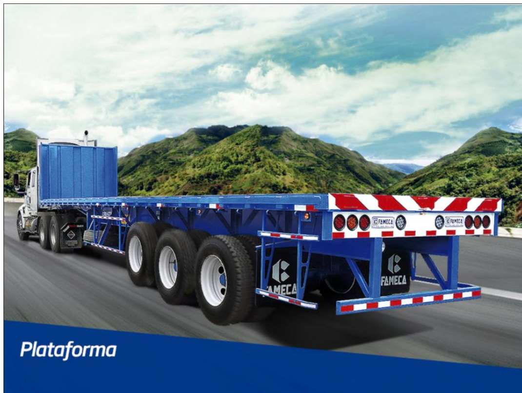
Figura 6. Semirremolque Plataforma Suspensión neumática llantas dual
