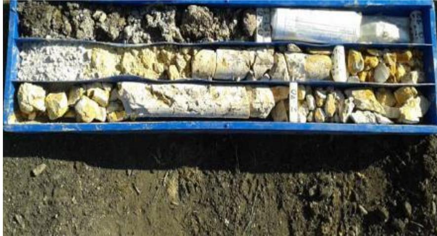
Fotografía 3: Perforación 1. De 0,00 m a 3,00 m
