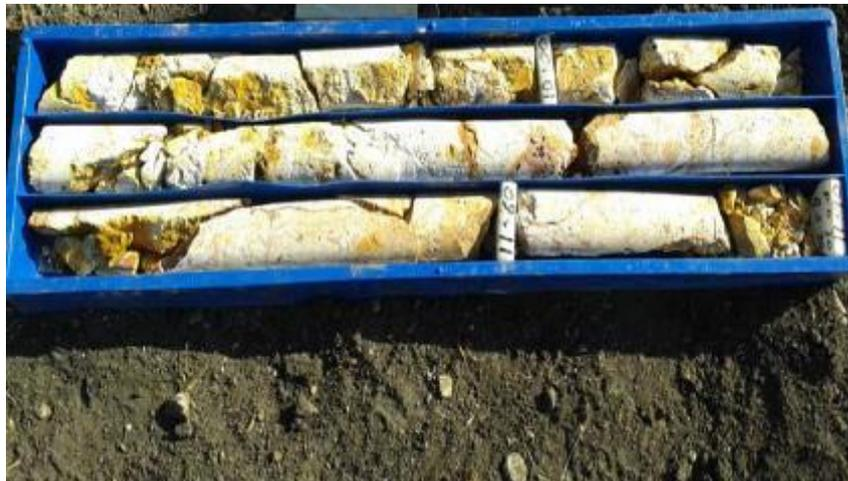
Fotografía 4: Perforación 1. De 9,40 m a 11,90 m
