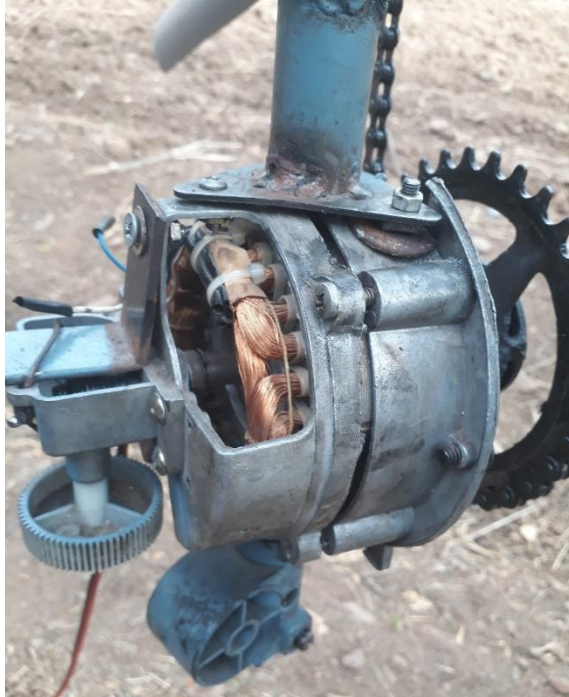
Figura 52: Motor del generador eólico Fuente: Elaboración propia
