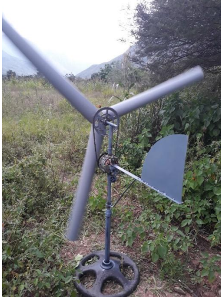
Figura 46: Implementación del generador eólico
