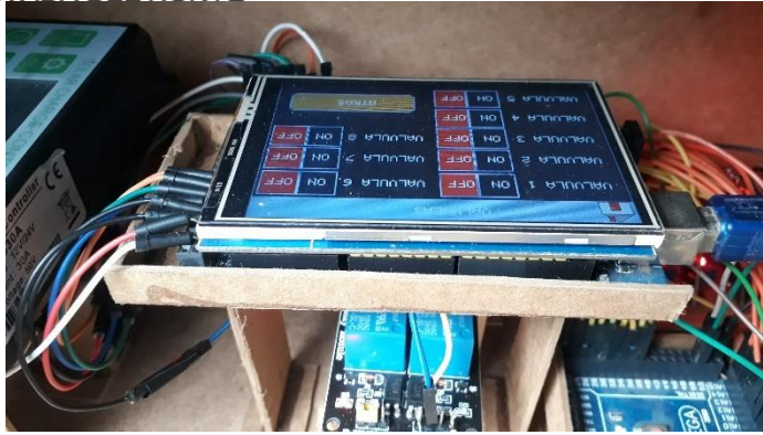
Figura 57: Instalación de pantalla TFT LCD Fuente: Elaboración propia
