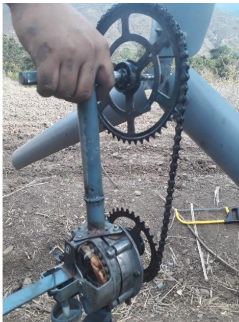
Figura 53: Instalación del generador eólico Fuente: Elaboración propia
