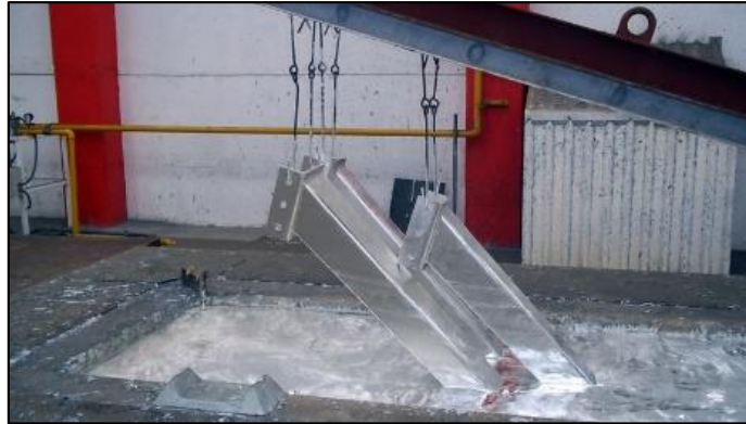
Figura 10: Proceso de Galvanizado en Caliente.
