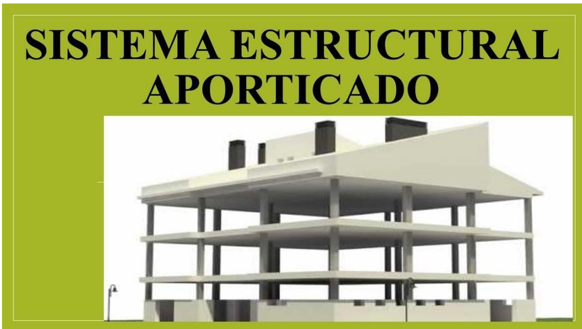
Imagen 4 Representación gráfica del sistema Estructural Aporticado.
