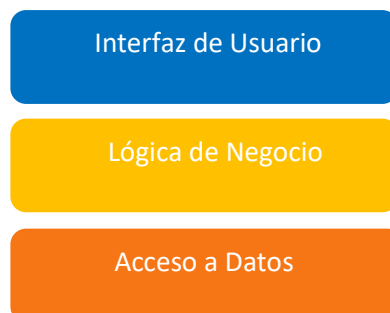
Figura 129: Arquitectura de N capas
