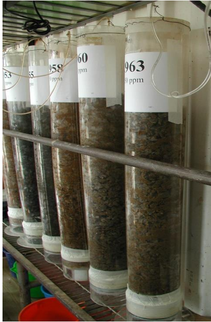
Fig.2 Columnas de lixiviación de 6” de diámetro
