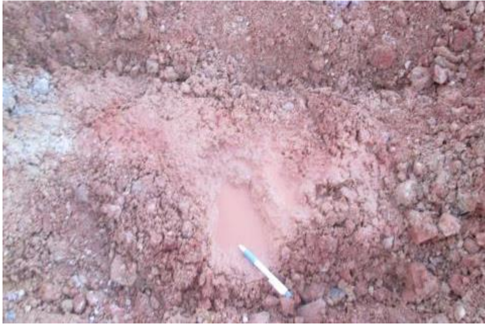
Foto 11. Prueba de percolación en la parte superior del mineral descargado
