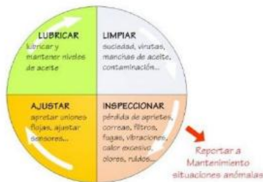
Figura 2 Tareas del mantenimiento autónomo
