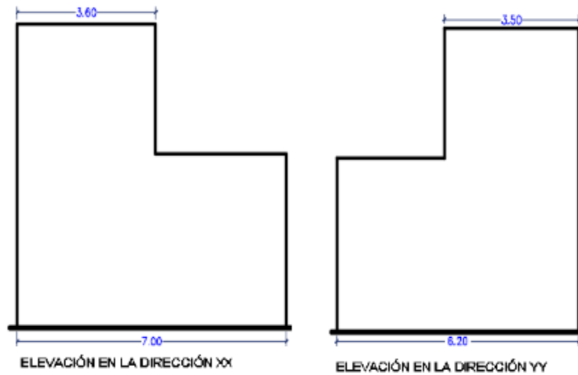
Figura 59: Verificación de la irregularidad geométrica vertical.
