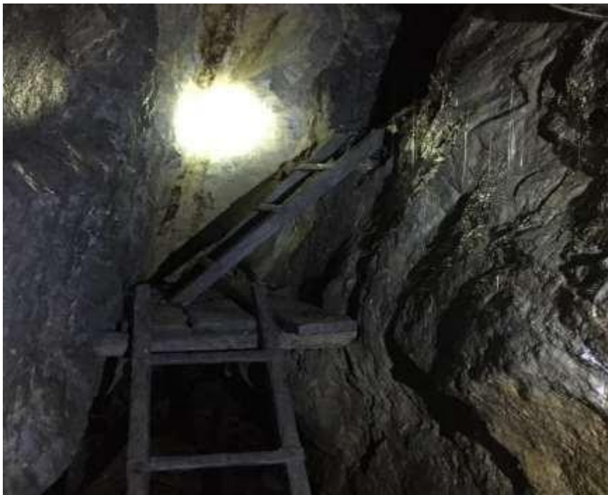
Fotografía 18: Chimenea de trabajo de la mina nivel 2, nueva esperanza trinidad. Fuente: Elaboración Propia.
