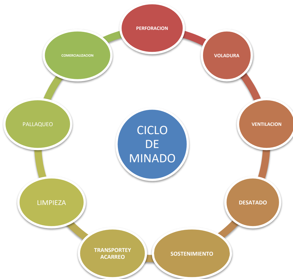
Ilustración 10: Flujoograma del ciclo de minado de la Mina Nivel 2, Nueva Esperanza Trinidad.
