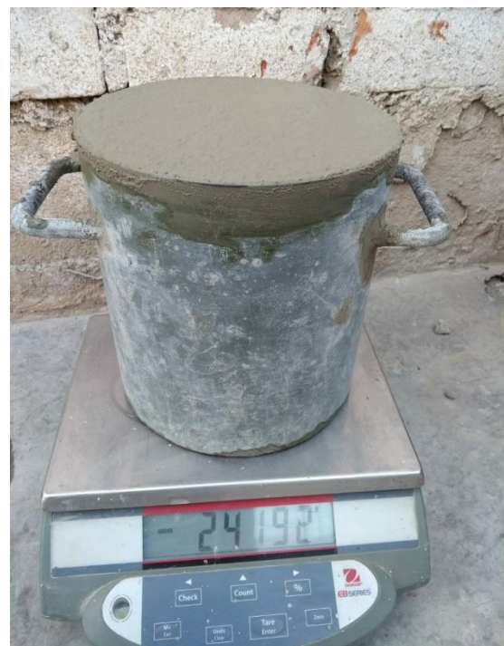
Foto. 16: Temperatura y peso unitario del concreto.
