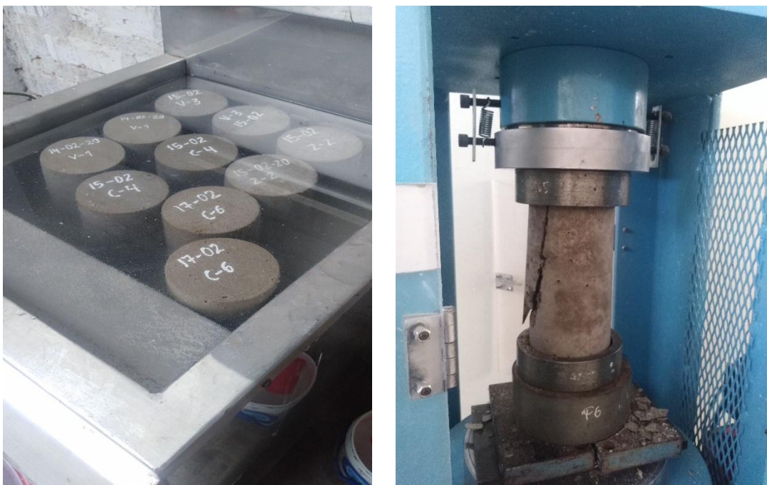
Foto. 14: Curado probetas y rotura en la prensa en laboratorio de concreto de la UPN, San Isidro.
