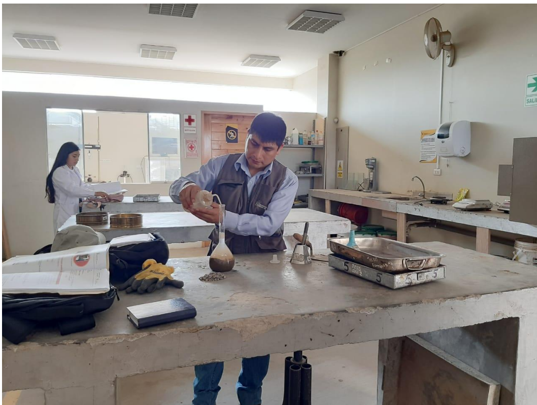
Foto. 12: Análisis físico de agregado fino, en laboratorio de concreto de la UPN, San Isidro.
