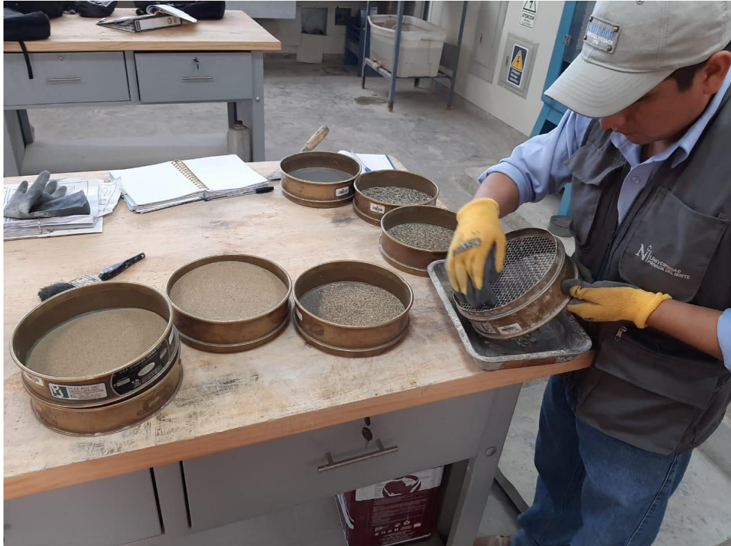
Foto. 10: Análisis granulométrico de agregado fino, en laboratorio de concreto de la UPN, San Isidro.
