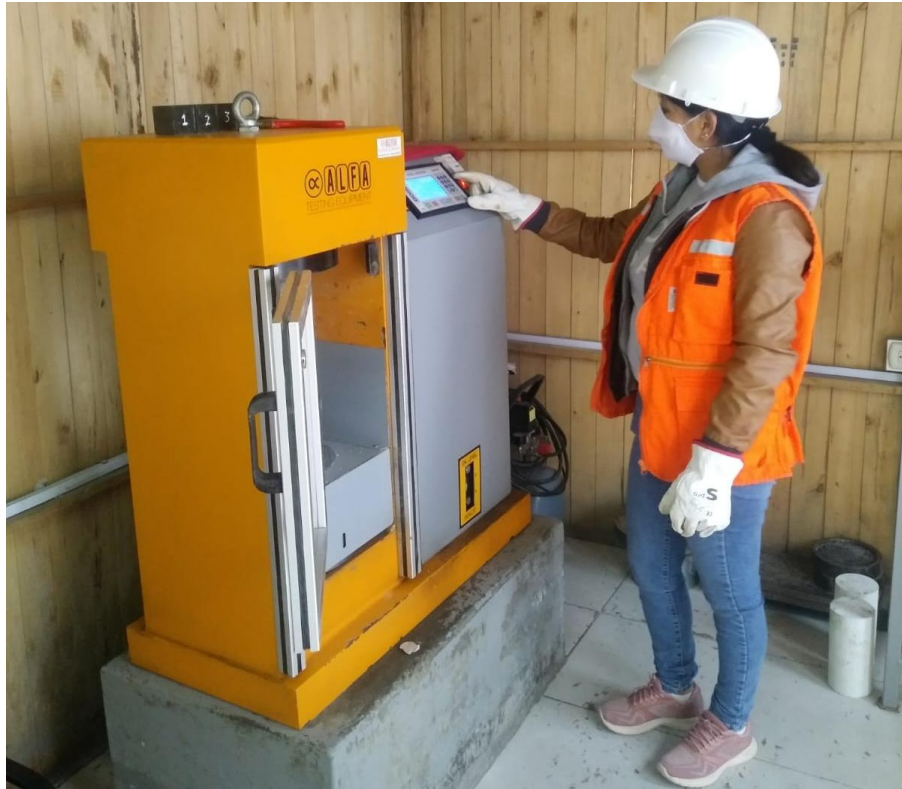
Foto. 17: Verificación de prensa para ensayo de resistencia a compresión en laboratorio QCE.
