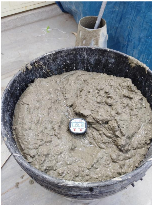
Foto. 16: Temperatura y peso unitario del concreto.
