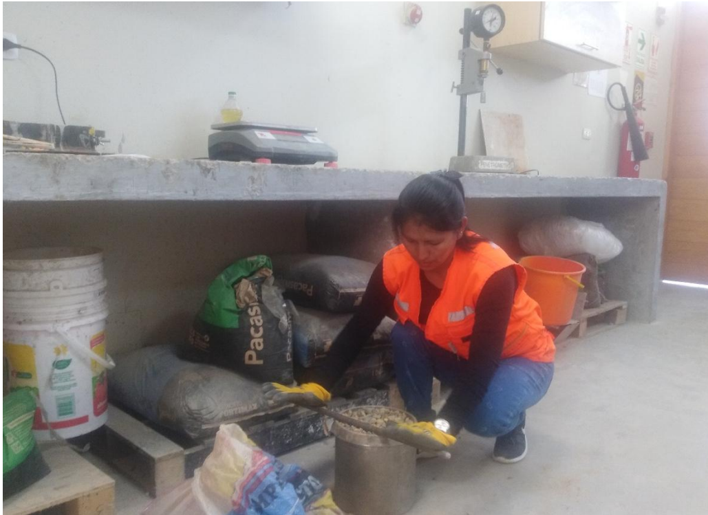
Foto. 11: Peso unitario compactado de agregado grueso, en laboratorio de concreto de la UPN, San Isidro.
