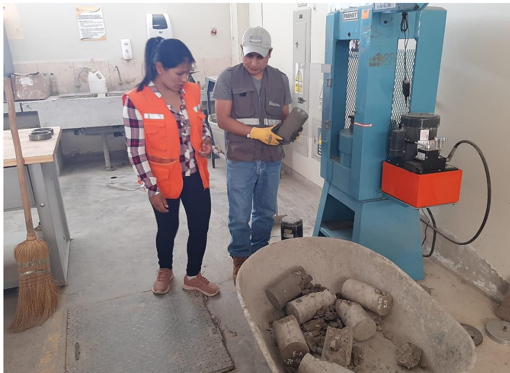
Foto. 14: Verificando el tipo de fallas producto de la rotura de probetas, en laboratorio de concreto de la UPN, San Isidro.
