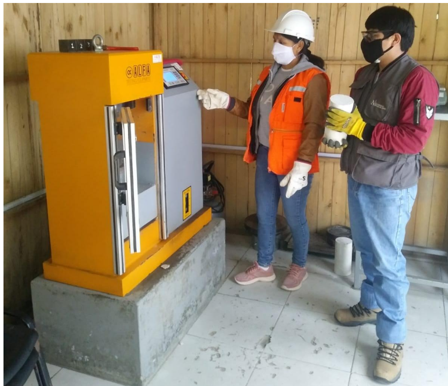
Foto. 18: Ensayo de resistencia a compresión de probetas en laboratorio QCE.
