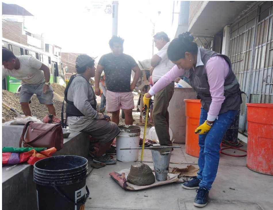
Foto. 3: Ensayo de asentamiento en el sector Jerusalén
