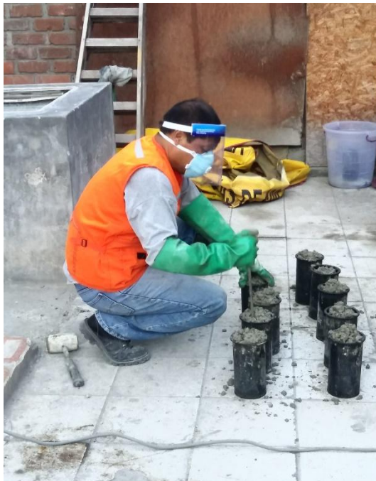
Foto. 15: Preparación de concreto patrón, ensayo de Slump y conformación de probetas.
