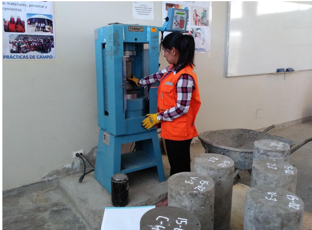
Foto. 13: Ensayo de resistencia a compresión de probetas, en laboratorio de concreto de la UPN, San Isidro.
