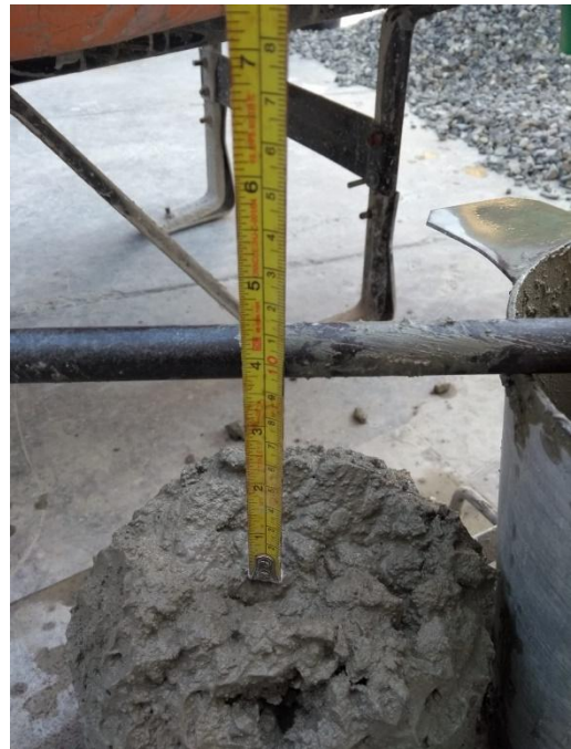
Foto. 15: Preparación de concreto patrón, ensayo de Slump y conformación de probetas.
