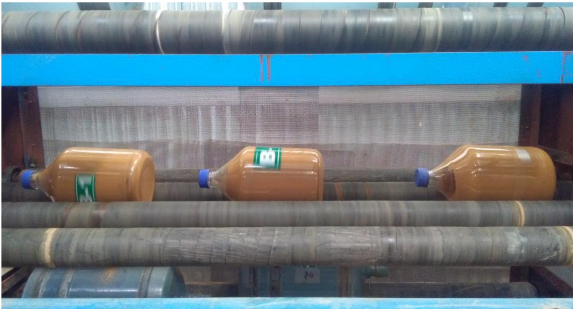
Foto N° 02: Mecanismos de agitación – prueba de rodillos con botellas
