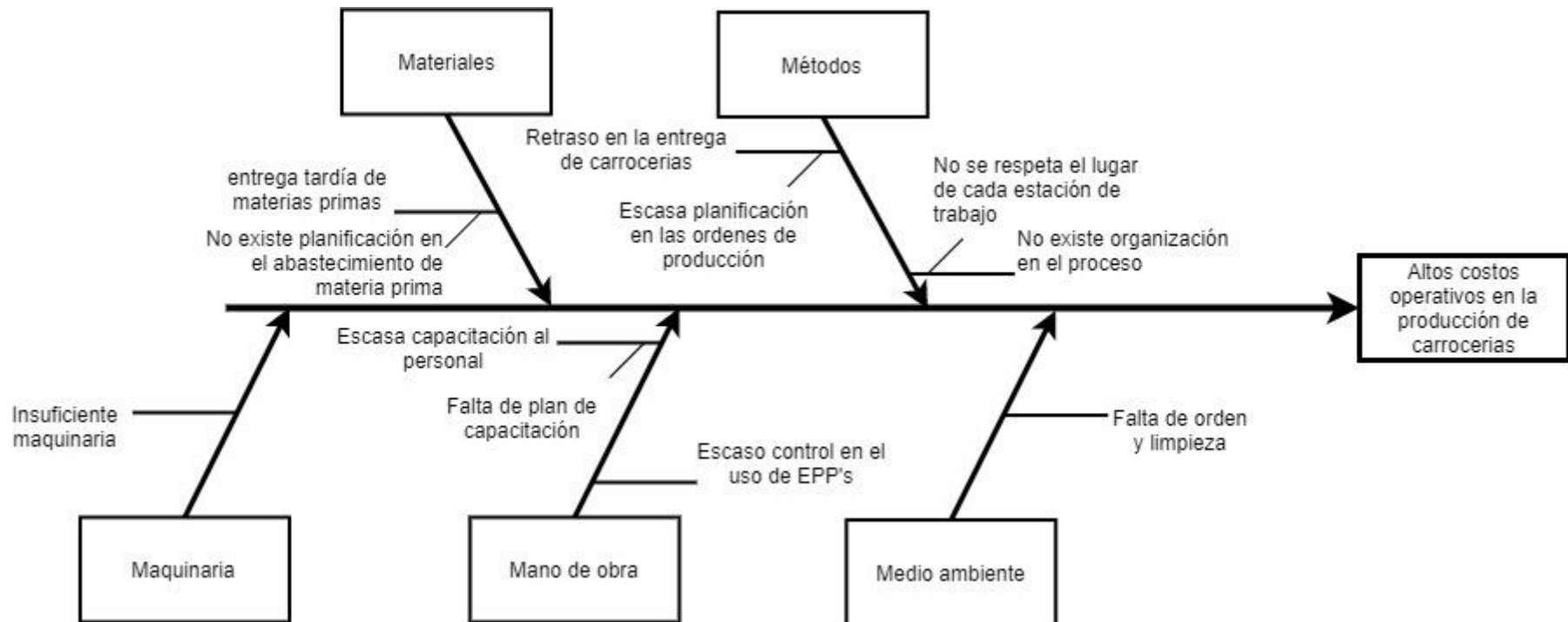
Figura 2. Diagrama Ishikawa de la producción de carrocerías en la empresa Halcón S.A
