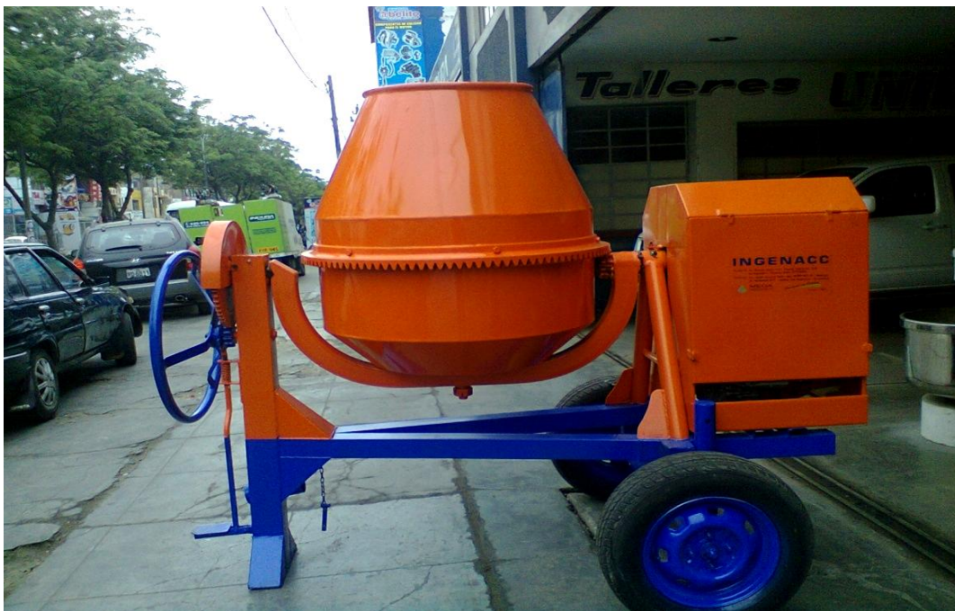
Figura 24. Mezcladora tipo trompo de tambor basculante 11P 3
