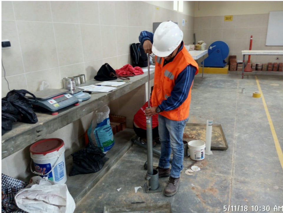
FOTO 8. En la imagen se aprecia al tesista realizando el ensayo de Proctor Modificado
