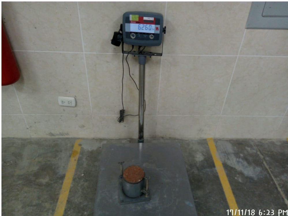
FOTO 9. En la imagen se aprecia el pesado del molde de Proctor Modificado con material para afirmado
