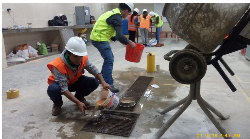
FOTO 3. En la Imagen se aprecia al tesista realizando el ensayo de tamizado por lavado
