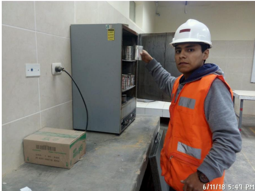
FOTO 4. En la imagen se aprecia al tesista colocando las taras al horno para el secado del material
