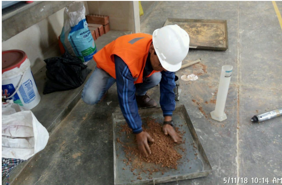
FOTO 6. En la imagen se aprecia al tesista preparando el material de Afirmado para el ensayo de Proctor Modificado
