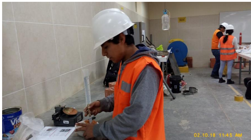
FOTO 2. En la Imagen se aprecia al tesista realizando el ensayo de límites de Atterberg.
