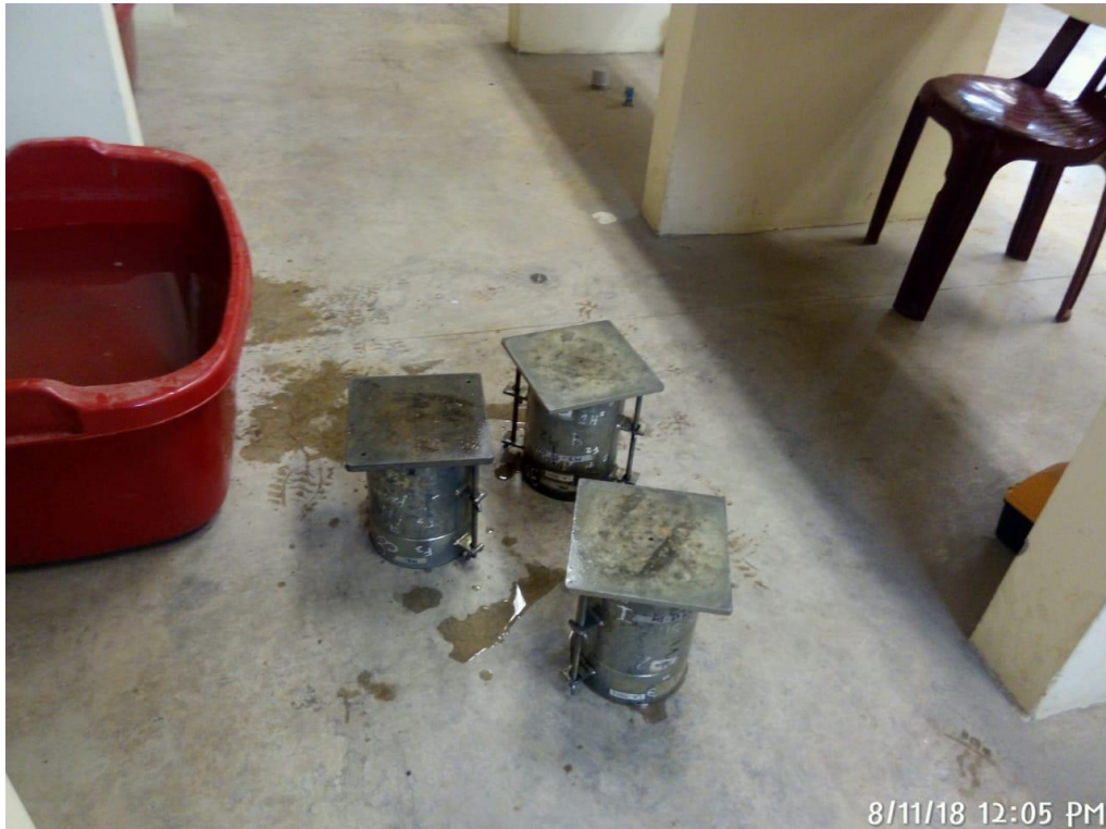
FOTO 10. En la imagen se aprecia a los moldes de CBR drenando luego de estar sumergidos en agua
