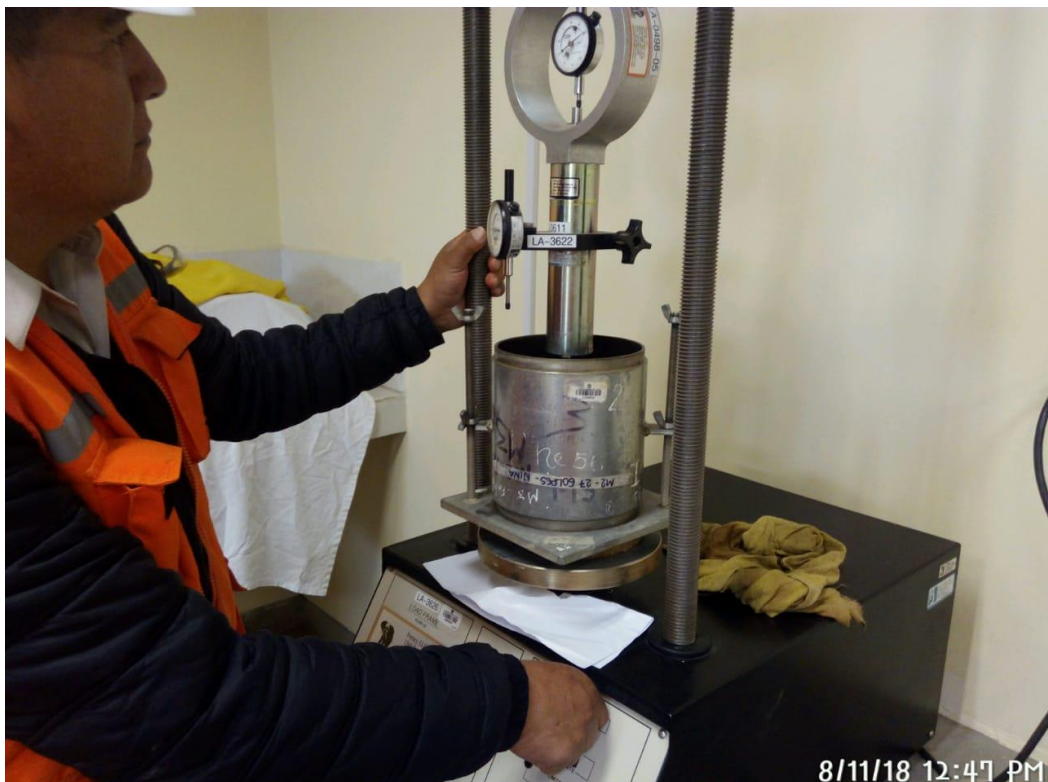
FOTO 11. En la imagen se aprecia al encargado de laboratorio preparando la prensa hidráulica para el ensayo de penetración
