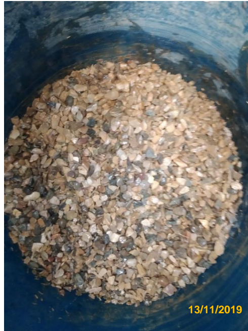
Figura 6. Capa de 0.10 m de confitillo
