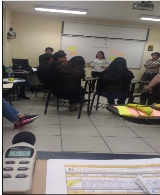
Foto 15. Medición de ruido con sonómetro en el A202.
