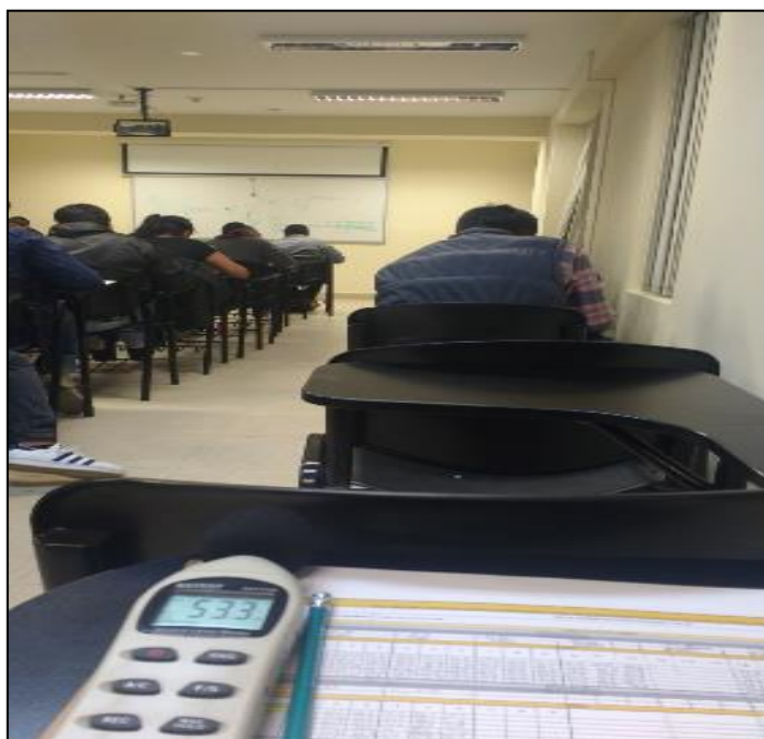
Foto 13. Medición de ruido con sonómetro en el A306
