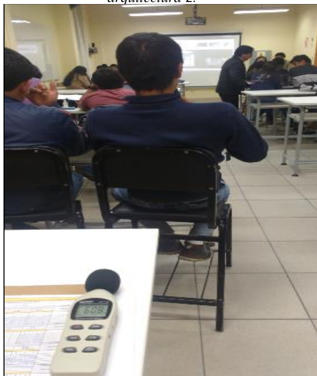
Foto 19. Medición de ruido con sonómetro en el Taller de arquitectura 2.
