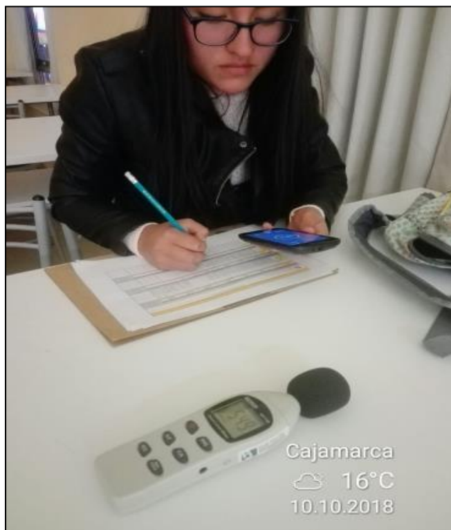
Foto 21. Medición de ruido con sonómetro en el taller de arquitectura 3.
