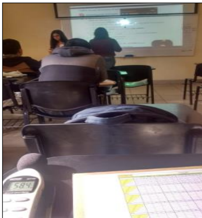
Foto 11. Medición de ruido con sonómetro en aula A202.
