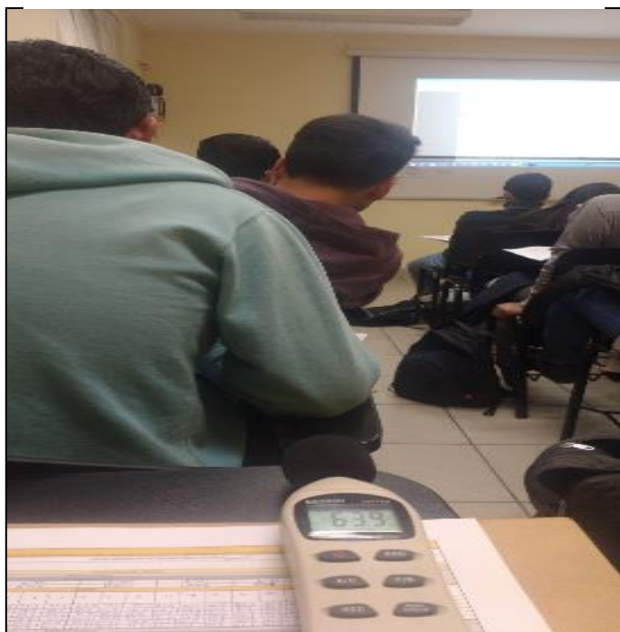
Foto 12. Medición de ruido con sonómetro en el A203.
