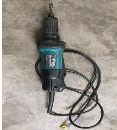
Figura 33. Rectificador. Fuente: Bona Logistic
