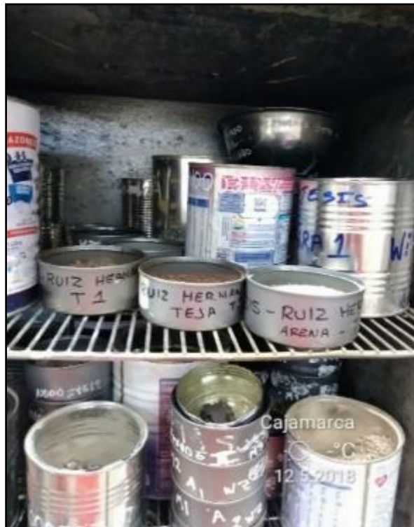
FIGURA 5: Contenido humedad de cerámica, teja de arcilla y ladrillo triturado.
