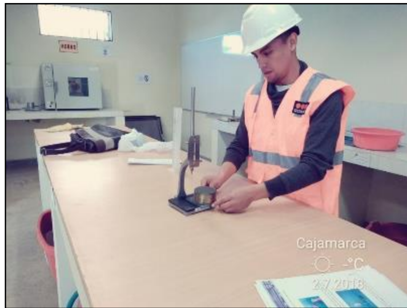
FIGURA 11: Consistencia normal del cemento.
