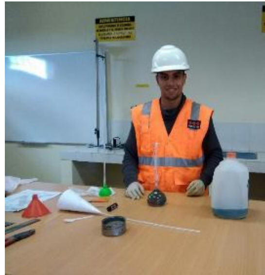
Fotografía 18: Frasco de "Le Chatelier" con gasolina hasta la marca 0.
