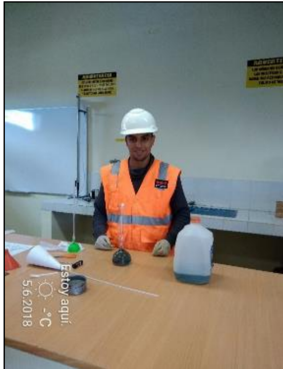
FIGURA 10: Peso específico del cemento hidráulico.
