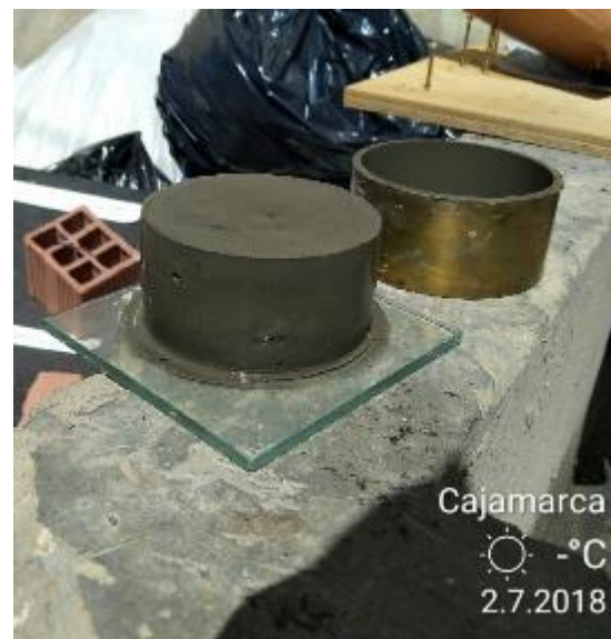
Fotografía 30: Morteros antes de colocarlo ha curado.
