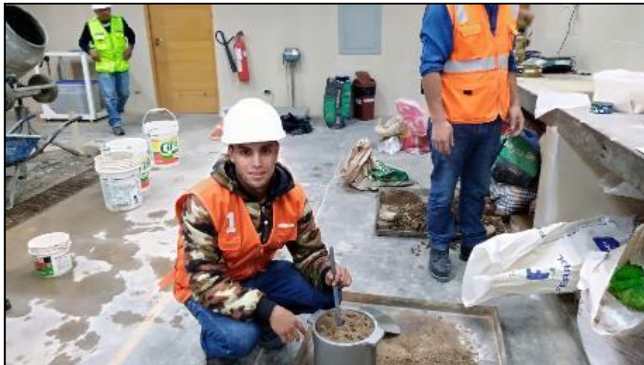
FIGURA 8: Peso Unitario, método apisonado
