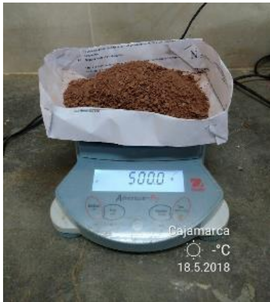
Fotografía 15: Pesar 500 gr de material a ensayar
