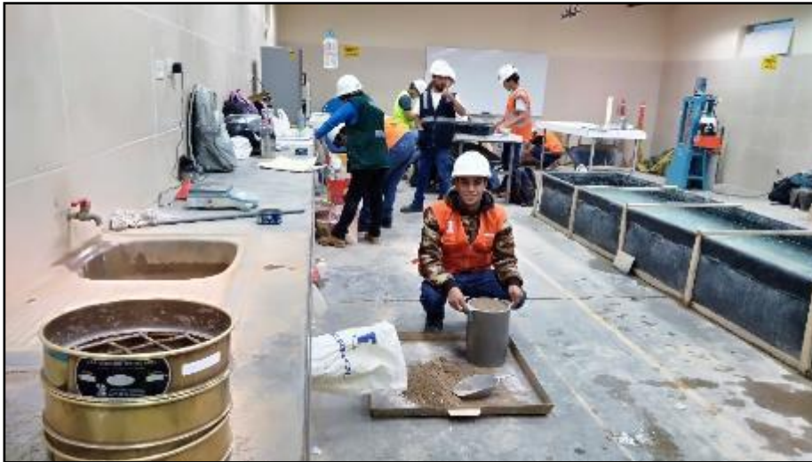
FIGURA 9: Peso unitario, método llenado con cucharón de mano.
