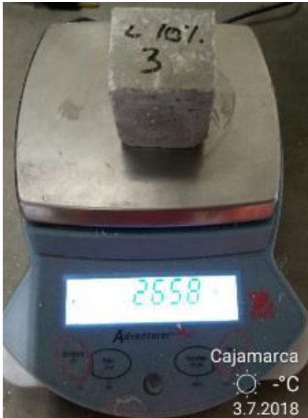
Fotografía 37: Peso seco del cubo de mortero después de sacarlo del horno.
