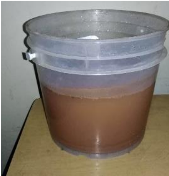
Fotografía 13: Material colocado en un recipiente con agua, dejar reposar durante 24 horas.
