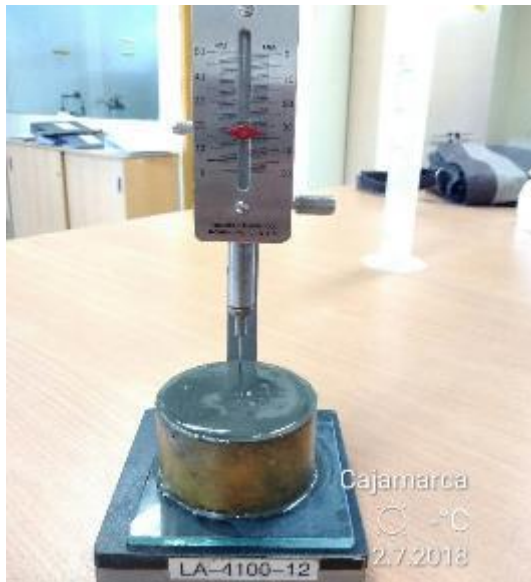
Fotografía 29: Penetración del cemento portland andino tipo V a través del aparato de Vicat
