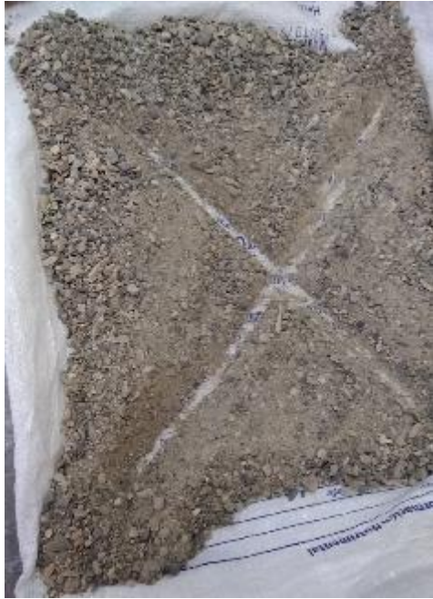
Fotografía 9: Cuarteo del Material
