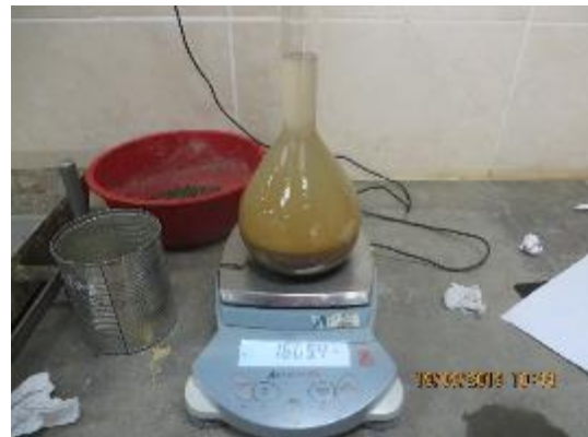
Fotografía n° 16. Peso de fiola más material más agua temperada.
