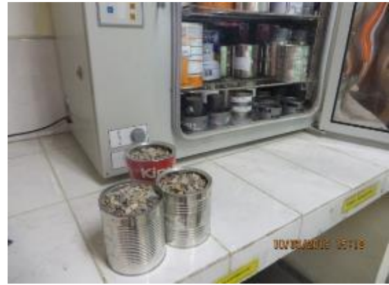
Fotografía n.º 4. Secado en horno de laboratorio agregado grueso de 3/8" para ensayo de granulometría.
