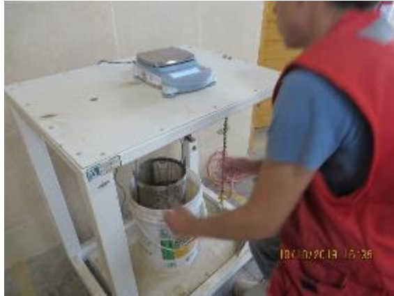
Fotografía n° 19. Peso del agregado sumergido en agua, ensayo de Peso específico.
