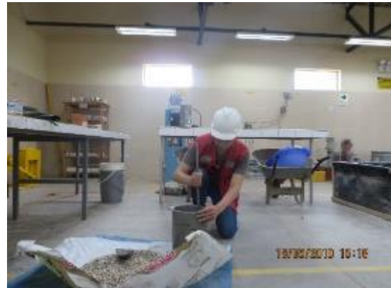
Fotografía n° 8. Compactación por capas con varilla lisa dando 25 golpes, ensayo de Peso Unitario compactado.
