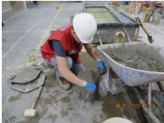
Fotografía n° 25. Nivelación de la última capa del ensayo de Peso unitario del concreto.
