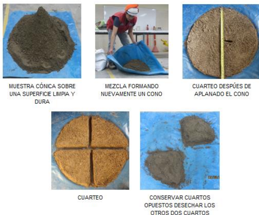
Figura 3. Cuarteo de material por el método C de la norma MTC E103. En la figura se muestran fotografías del procedimiento de cuarteo realizado durante la investigación. Fuente: Adaptado del Manual de Ensayos de Materiales, 2016.
