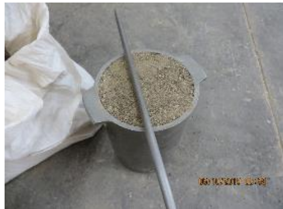
Fotografía n° 10. Nivelación con varilla metálica para pesar muestra + molde. Ensayo de Peso Unitario.
