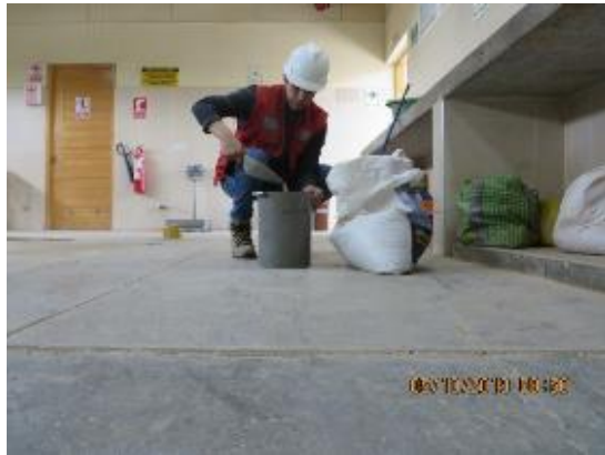
Fotografía n° 7. Ensayo de Peso Unitario suelto o compactado. Para el ensayo suelto dejar caer la muestra a 5 cm del borde del recipiente.
