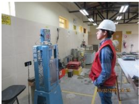
Fotografía n° 29. Ensayo a compresión de testigos cilíndricos de concreto.
