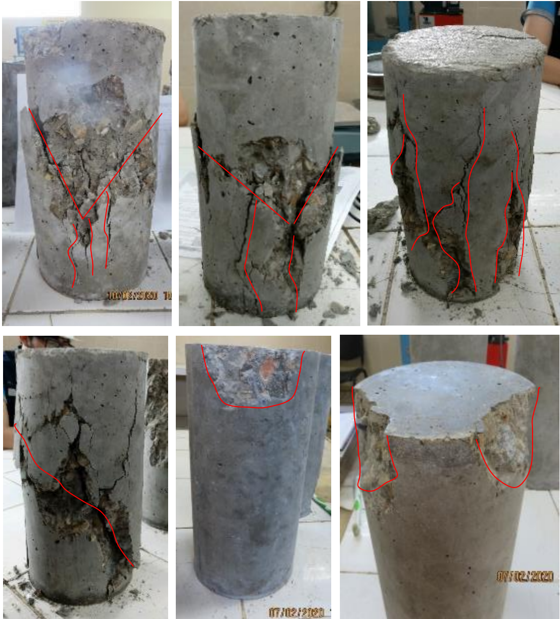
Figura 13. Tipo de falla de las probetas cilíndricas. Falla del tipo 2, 3, 4, 5 y 6; la línea roja marca la progresión de las grietas en cada probeta. Fuente: Elaboración propia.
