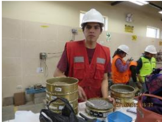
Fotografía n.º 3. Limpieza de tamices para ensayo de granulometría de agregado fino.
