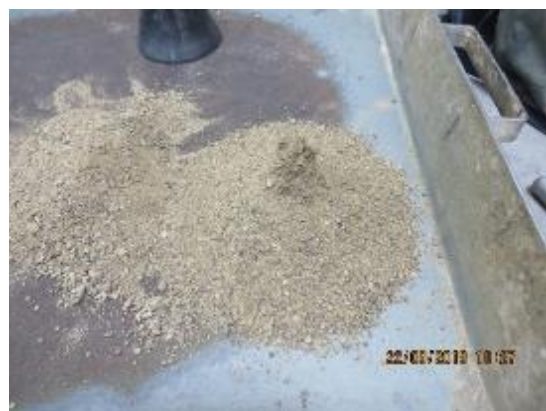
Fotografía n° 12. Prueba con tronco-cono para confirmar estado SSS del agregado fino.
