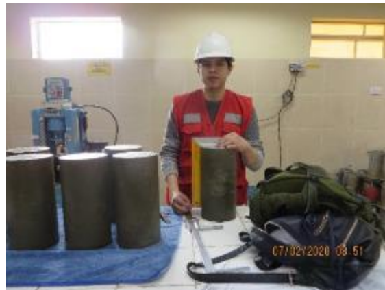
Fotografía n° 28. Verificación de la variabilidad dimensional de las probetas de concreto antes del ensayo a compresión.
