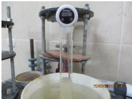
Fotografía n° 15. Fiola con material más agua al 100 % en baño maría para alcanzar temperatura normada.
