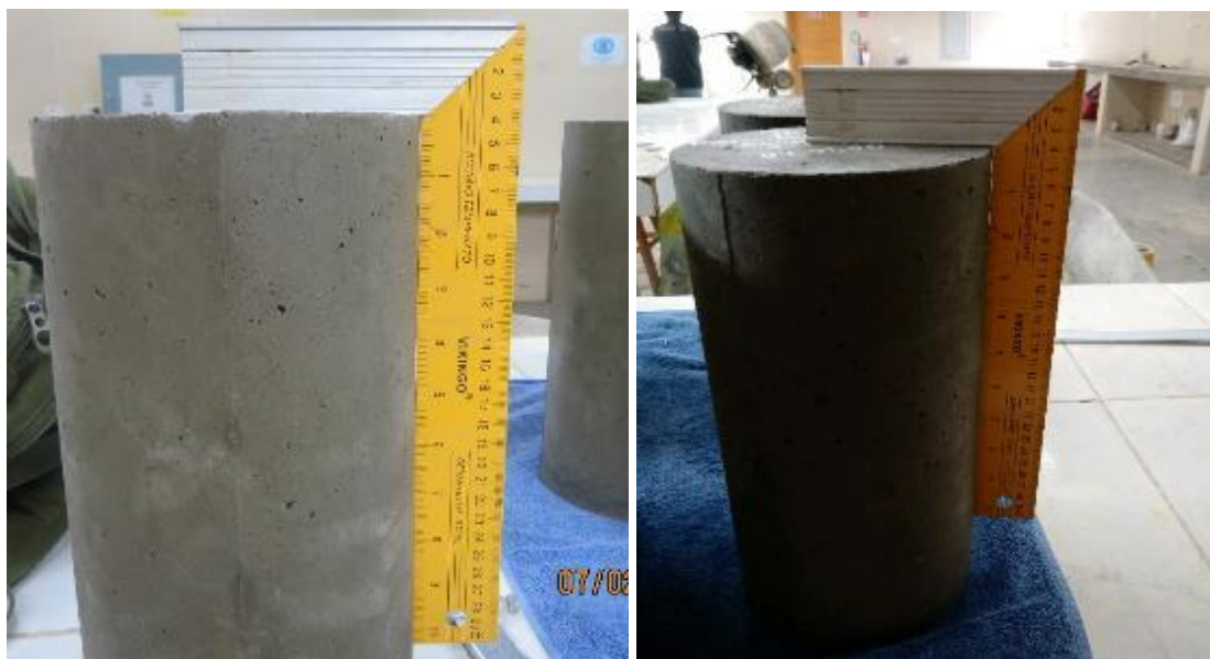
Figura 7. Perpendicularidad de testigos cilíndricos. Se utilizó una regla escuadra para comprobar que la desviación del eje vertical. Fuente: Elaboración propia.
