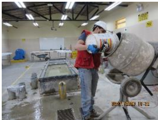
Fotografía n° 21. Elaboración de las mezclas de concreto diseñadas.
