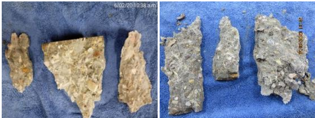
Figura 14. Unión Pasta - Agregado después del ensayo a compresión. La falla se presentó en la pasta de cemento y el agregado, Fuente: Elaboración propia.
