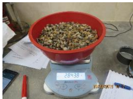
Fotografía n° 18. Agregado grueso pesando en estado SSS.
