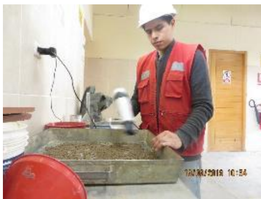
Fotografía n° 11. Secado de agregado fino con secadora de cabello para alcanzar el estado SSS.
