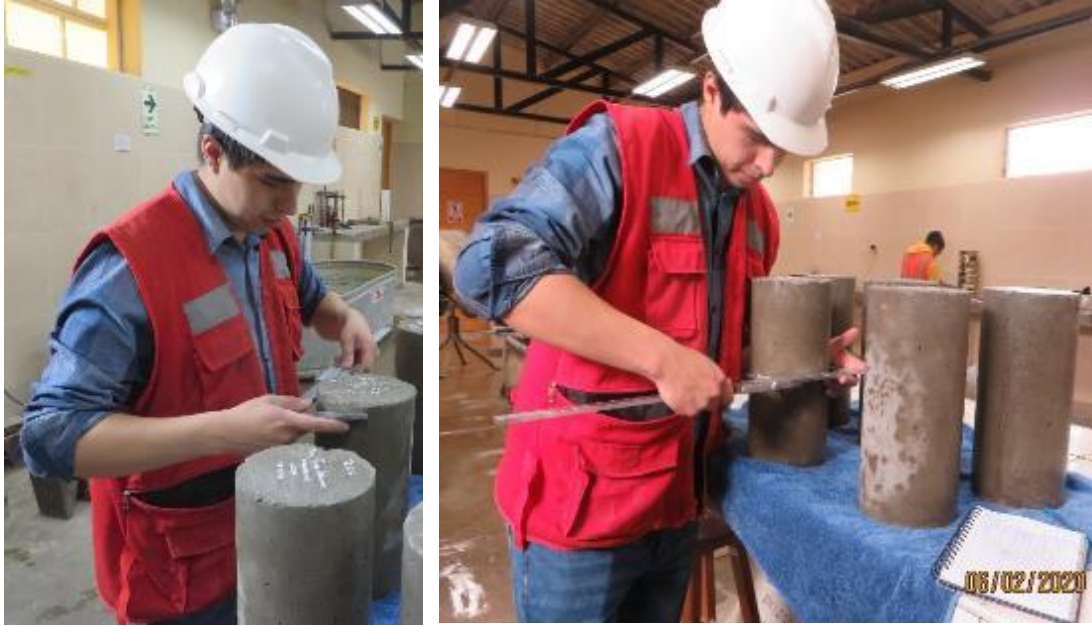
Figura 8. Variabilidad dimensional de testigos cilíndricos. Con un vernier de precisión 0.01 mm se comprobó que la diferencia entre diámetros sea menor de 2%. Fuente: Elaboración propia.
