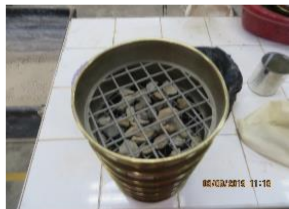
Fotografía n.º 6. Agregado grueso separado por tamaños en tamices del ensayo de granulometría.
