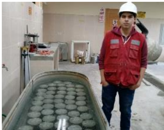
Fotografía n° 27. Curado de probetas de concreto en agua potable por 28 días.
