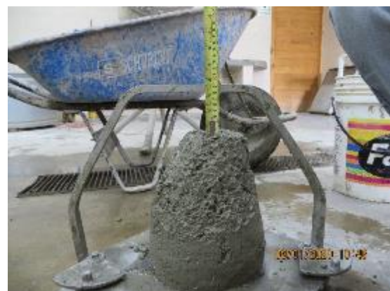
Fotografía n° 24. Mezcla con consistencia plástica, slump entre 3" y 4".
