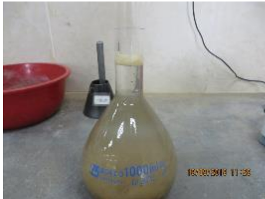
Fotografía n° 13. Fiola con contenido de muestra más agua al 90% de su capacidad. Ensayo de Gravedad específica.
