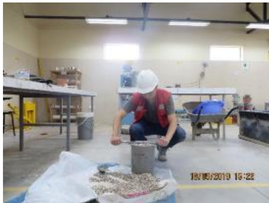
Fotografía n° 9. Eliminación de material excedente en última capa de compactación, ensayo de Peso Unitario.
