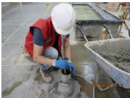
Fotografía n° 23. Compactación de la primera cada del ensayo de Slump con el cono de Abrams.
