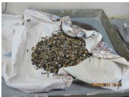
Fotografía n° 17. Ensayo de peso específico, agregado grueso totalmente saturado, secado con trapo.
