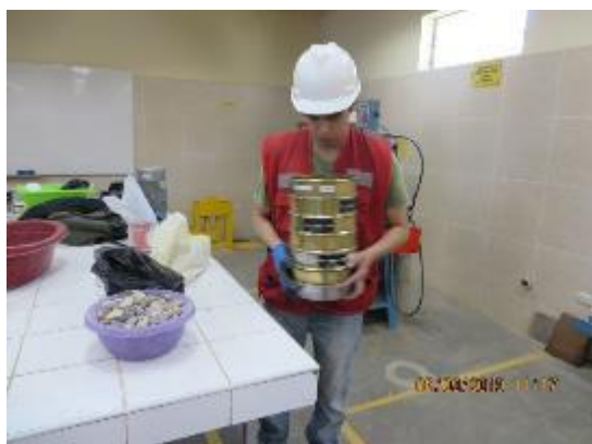
Fotografía n.º 5. Movimiento de tamices, ensayo de granulometría, procedimiento para agregado fino y grueso.
