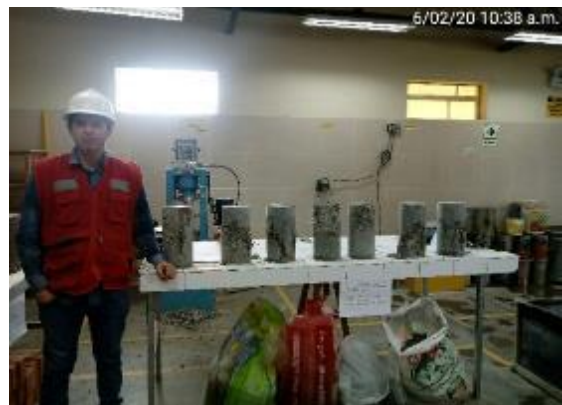
Fotografía n° 30. Fallas en probetas después del ensayo a compresión.
