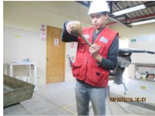
Fotografía n° 14. Eliminación de burbujas de aire en la fiola mediante agitación y rotación del instrumento.
