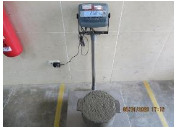
Fotografía n° 26. Peso de molde más concreto, ensayo de Peso Unitario.
