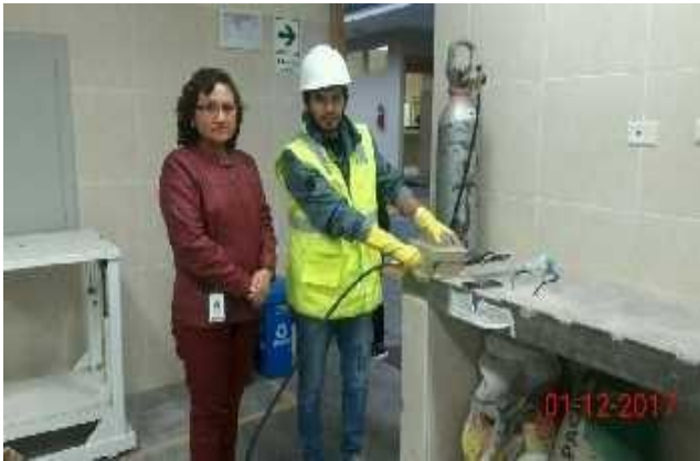
Figura 35: Inyección del CO 2 con un tiempo de 10 s por orificio que tenga el molde
