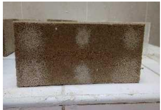
Figura 38: Puntos de inyección de CO 2
