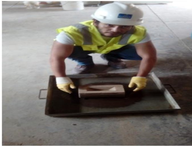
Figura 11: Unidad de albañilería en contacto con el agua.
