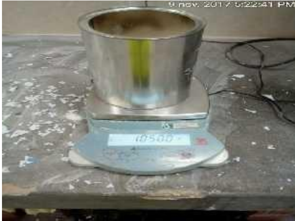
Figura 25: Peso de la muestra para granulometría
