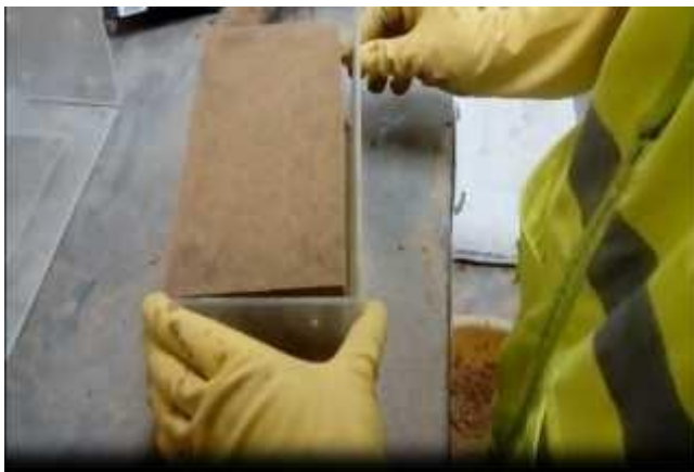
Figura 37: Desencofrado de ladrillo después de la inyección de CO 2
