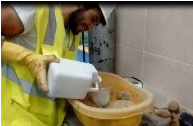
Figura 31: Medición del silicato de sodio
