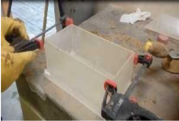
Figura 29: Aseguramiento del molde con abrazaderas
