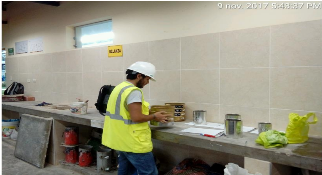
Figura 6: Tamizado del material.
