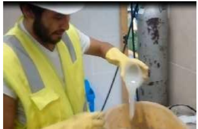
Figura 32: Vaciado del silicato sobre la arena
